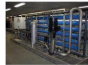
Verdunningsvloeistof uit mest met RO: ca. 0,55 m 3 water per m 3 mest
