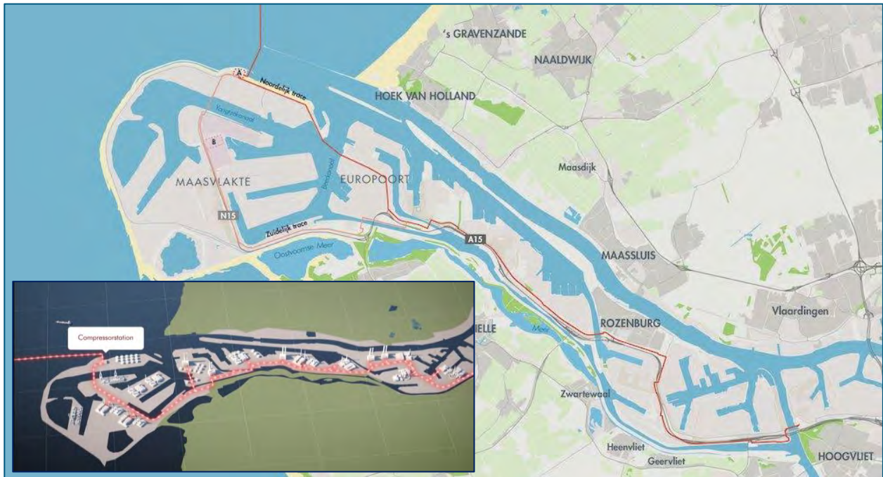
Figuur 2-2: Schematische weergave van de (mogelijk) ligging van transportleiding (verzamel-buisleiding) voor CO 2 in het havengebied, voor het afgevangen CO 2 van leveranciers. Inzet: schematische verbeelding van de transportleiding op land naar het compressorstation.
