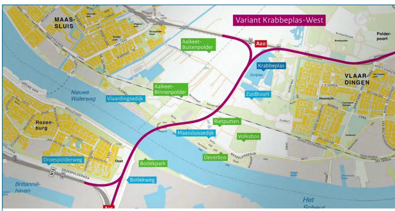
Figuur 7-1 Geplande aansluiting Blankenburgtunnel op de A15.
