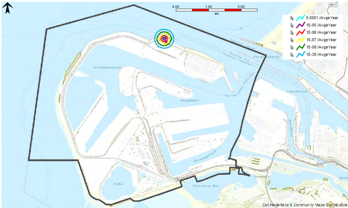
Figuur 9. Plaatsgebonden risico Compressorstation Edisonbaai en veiligheidscontour
