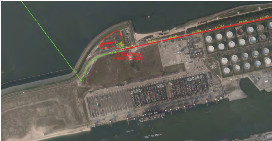
Figuur 3.17. Compressorstation Edisonbaai en kruising zeewering
