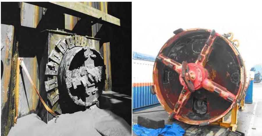
Figuur 3.33. Boorkop ten behoeve van gesloten front boortechniek
