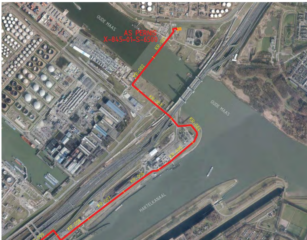
Figuur 3.8. Kruising van de Oude Maas vanaf Pernis middels een boring. Onderdoorgang spoor en A15
