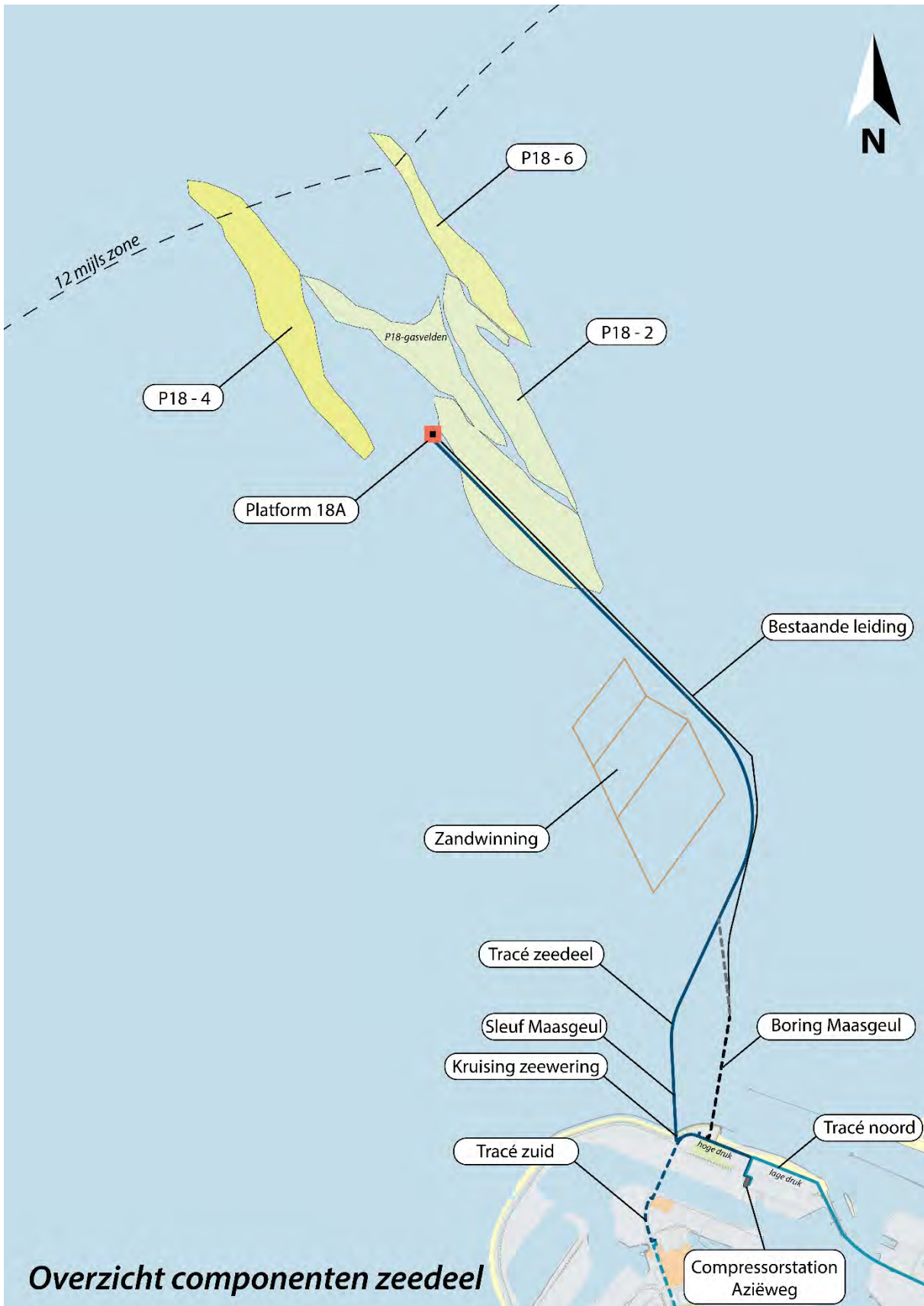
Figuur 5.2. Ligging zeedeel van de transportleiding
