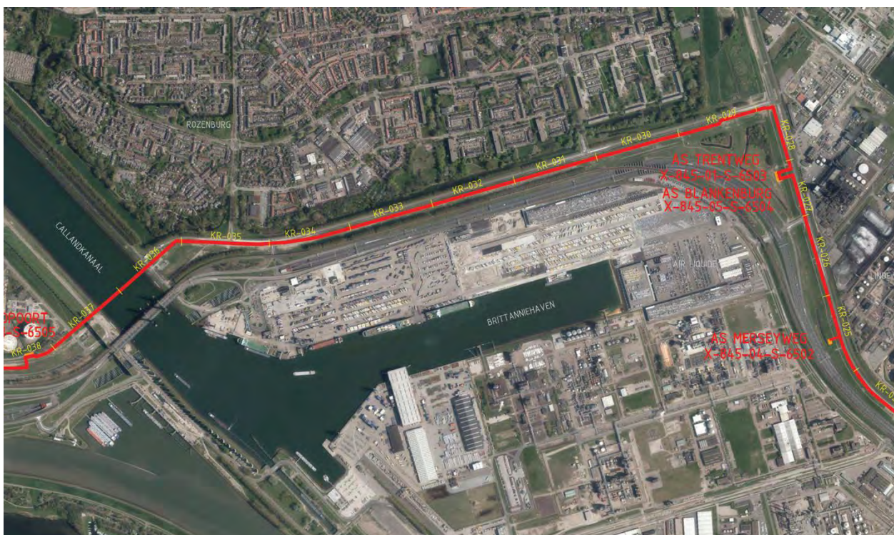
Figuur 3.11. Passage van Rozenburg en kruising Calandkanaal middels een boring
