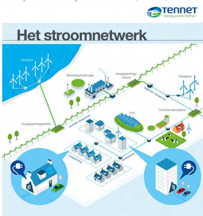
Afbeelding 1.4 Schematische weergave van het stroomnetwerk (bron: TenneT)
