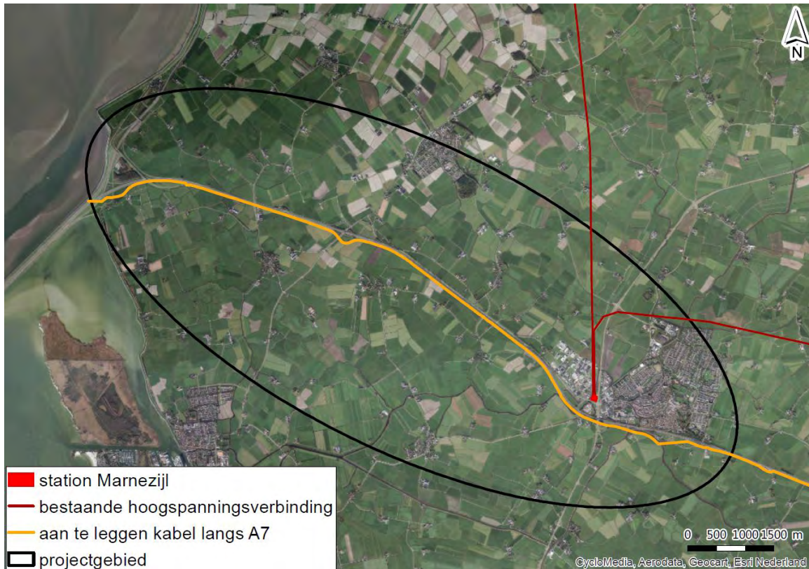
Afbeelding 1.5 Projectgebied. Het nieuwe station wordt aangesloten op de nieuw aan te leggen kabel langs de A7 en op station Marnezijl
