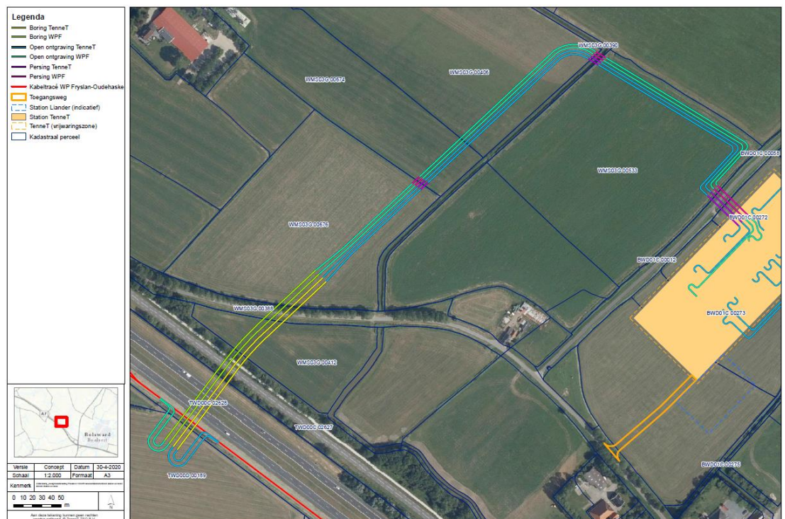
Figuur 2 Locatie kabeltracé
