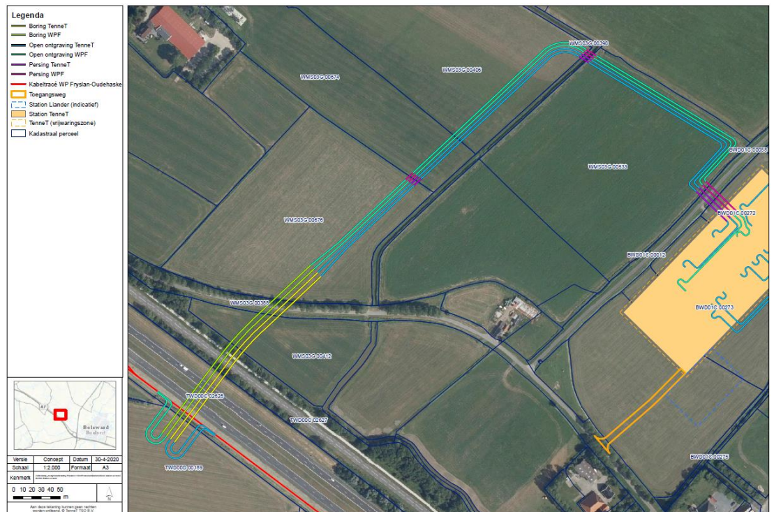
Figuur 2 Locatie kabeltracé
