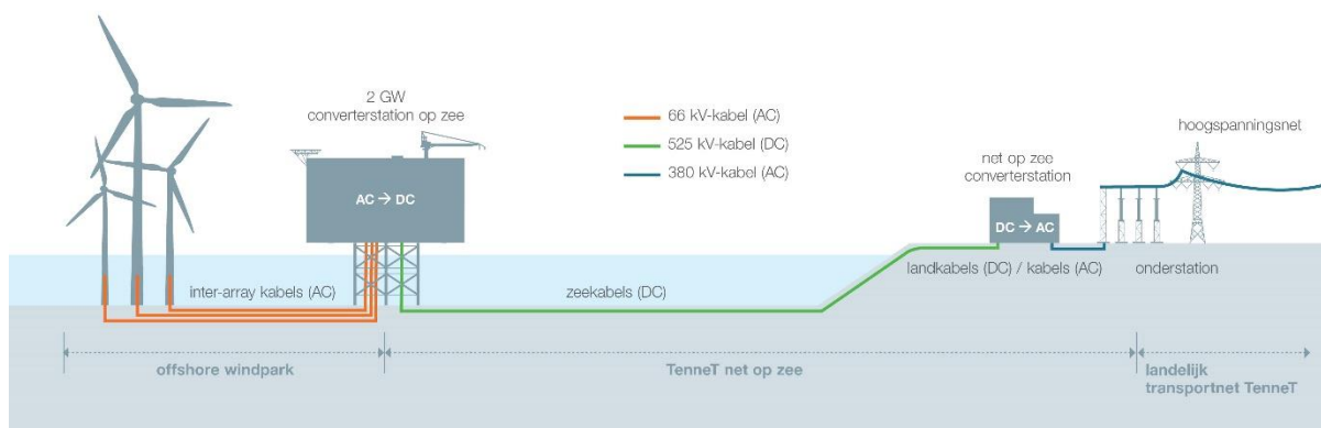
Figuur 0.2 Onderdelen project Net op zee IJmuiden Ver Beta: van platform op zee tot aansluiting op het 380kV hoogspanningsstation
