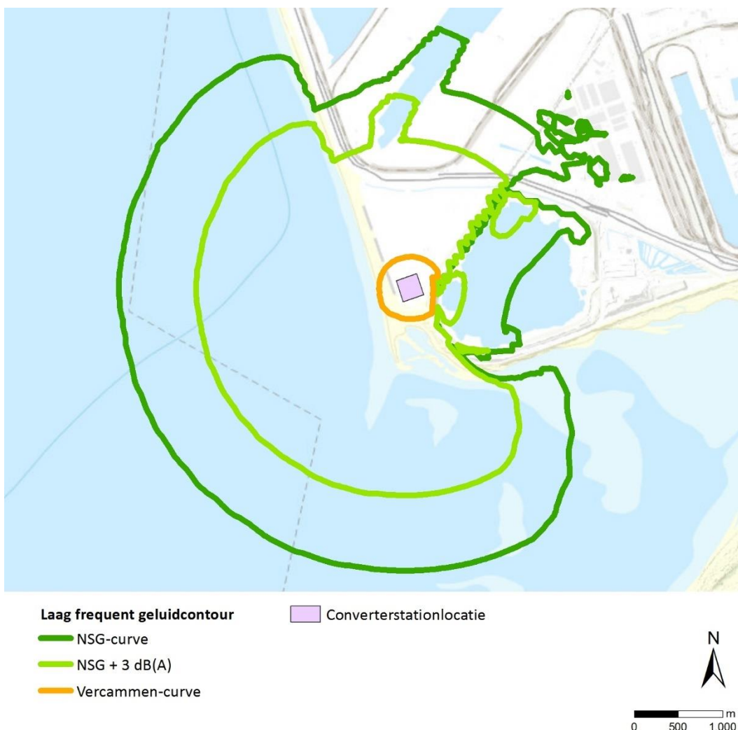
Figuur 9-30 NSG-curve en Vercammen-curve contouren laagfrequent geluid converterstation Maasvlakte Zuid
