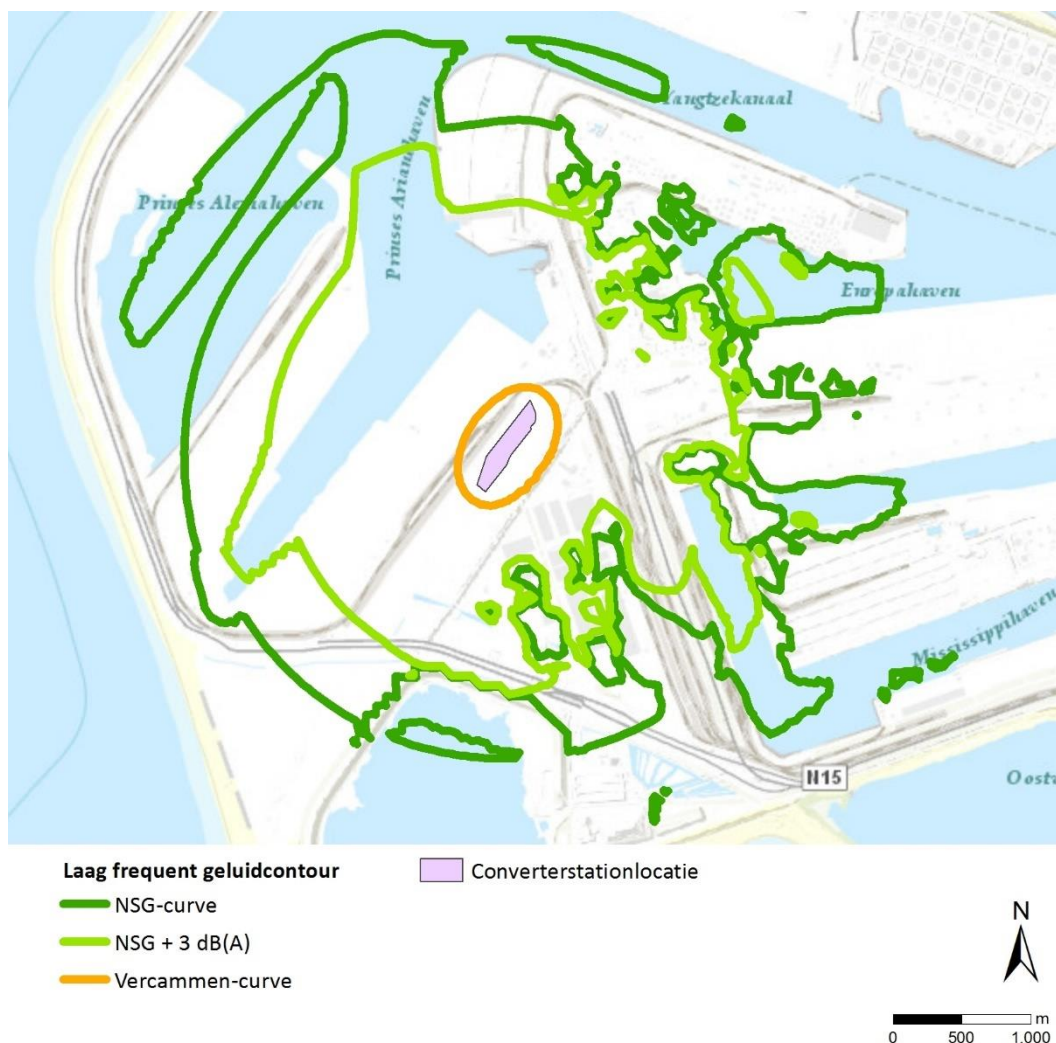
Figuur 9-28 NSG-curve en Vercammen-curve contouren laagfrequent geluid converterstation Maasvlakte Midden
