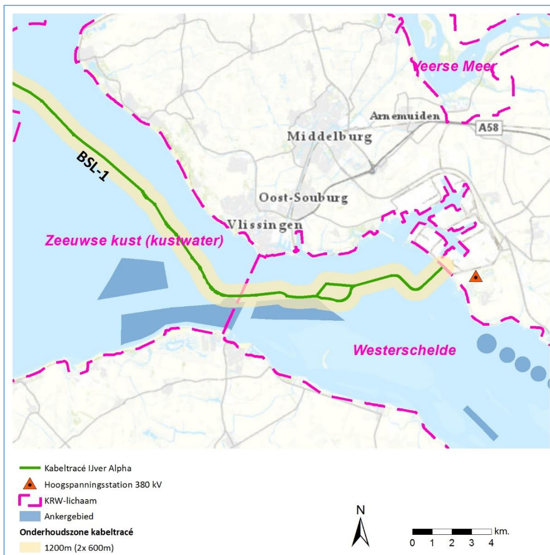
Figuur 4-66 Detailweergave aanlanding ten opzichte van KRW-oppervlaktewaterlichamen
