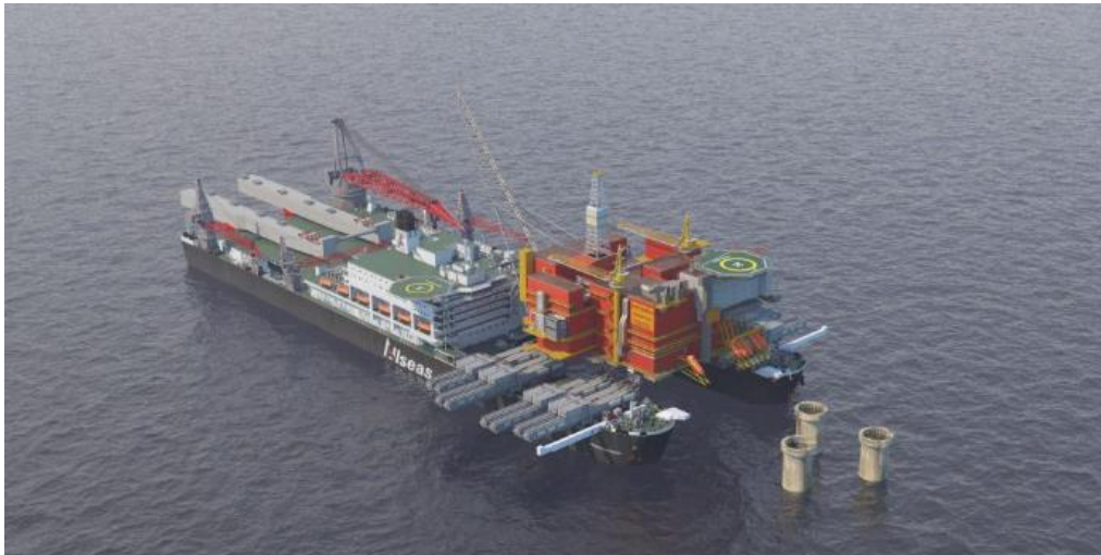
Figuur 1-1 Bovenbouw van onderen optillen m.b.v. een catamaranschip (hier: "Pioneering Spirit")
