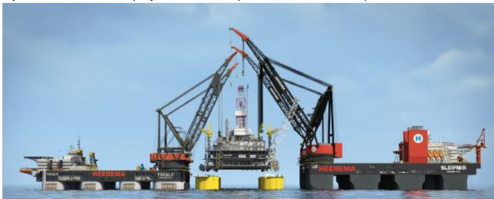
Figuur 1-2 Bovenbouw ophijsen met behulp van twee kraanschepen (hier: "Sleipnir" en "Thialf")
