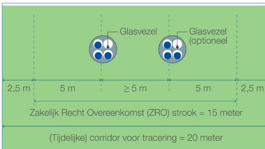
Figuur 2-9 Configuratie van de wisselstroomkabels op land bij een boring. ZRO = strook met zakelijk recht overeenkomst
