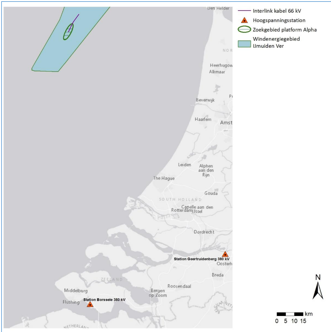
Figuur 2-12 Zoekgebied platform en 66kV-interlinkkabel op zee
