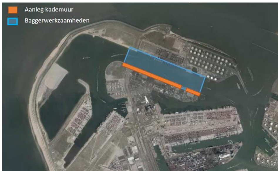
Figuur 5-31 Aanleg kademuur zuidzijde Yangtzekanaal (ook aan de noordzijde wordt een kademuur gerealiseerd; deze is niet op de figuur aangegeven).
