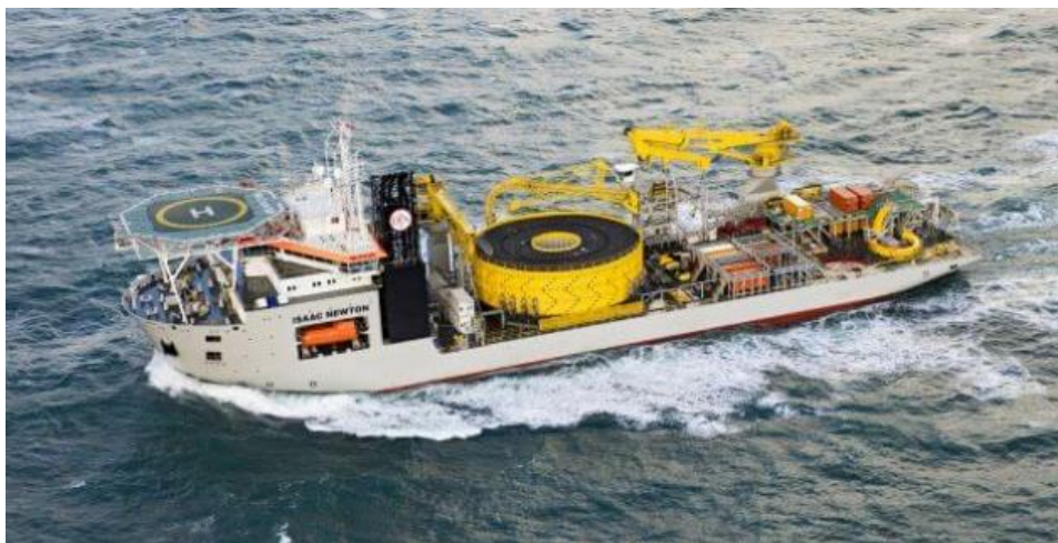
Figuur 5-3 Typische offshore CLV (Cable Lay Vessel)
