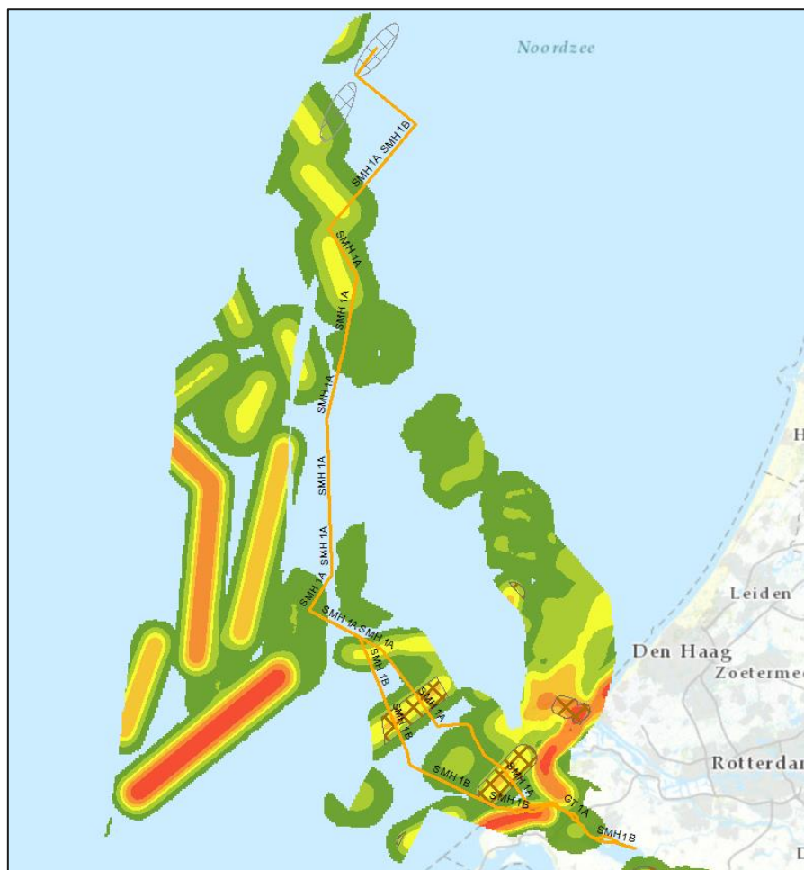
Figuur 2-25 Mine Risk Map en het tracéalternatief Simonshaven-1. In bruin zijn de 'non-ferrous' mijnenvelden aangegeven.
