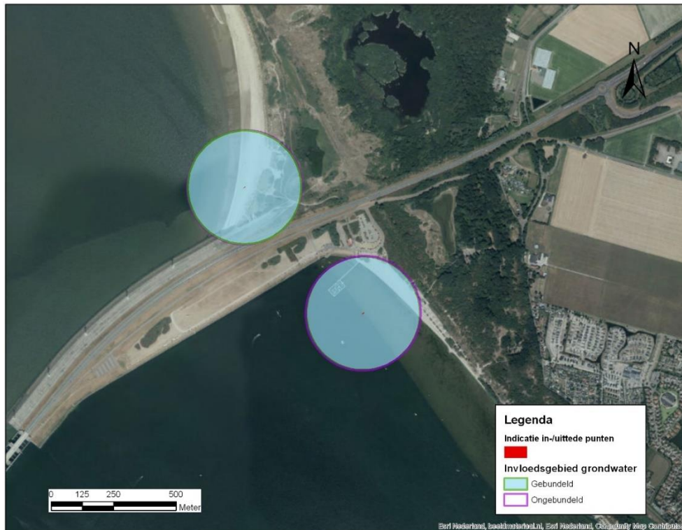
Figuur 3-1 Invloedsgebied grondwater als gevolg van bemaling – Haringvlietdam
