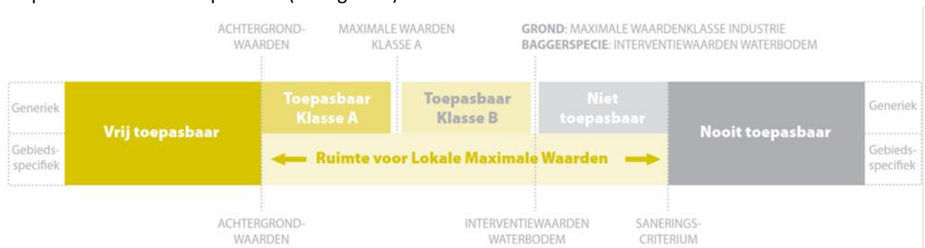
Figuur 1 Toetsingskader toepassen in waterbodem (Senternovem)
