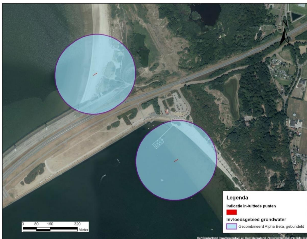
Figuur 3-2 Invloedsgebied grondwater als gevolg van bemaling bij een gecombineerde aanleg Alpha en Beta – Haringvlietdam
