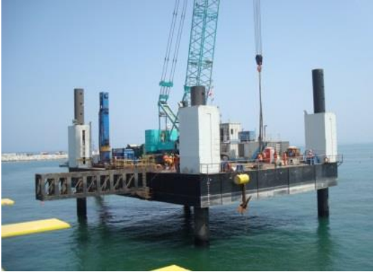
Afbeelding 2.6 Voorbeeld van een jack-up platform
