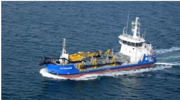
Afbeelding 2.3 Voorbeeld van een relatief kleine sleephopperzuiger met weinig diepgang
