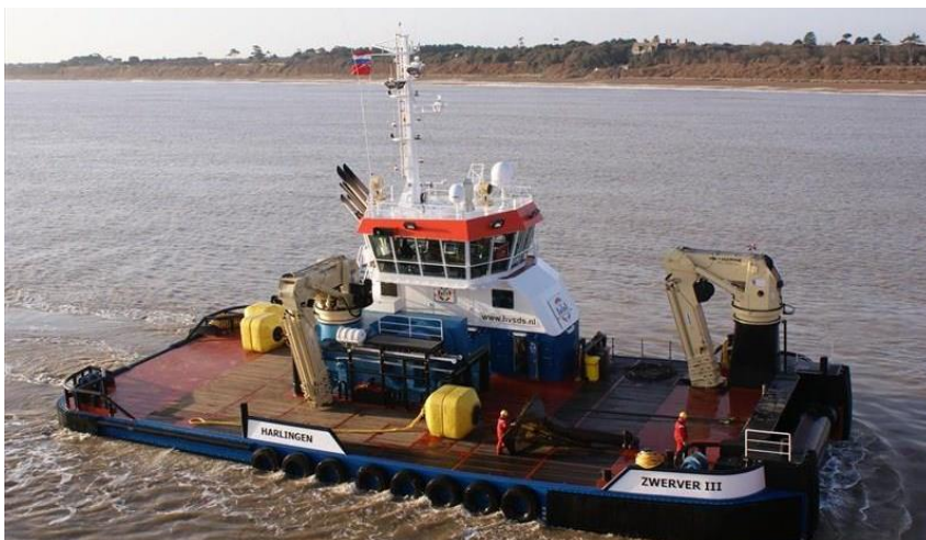
Afbeelding 4-1 Voorbeeld van een Multicat (Zwerver III) voor het verwijderen van buiten gebruik zijnde kabels
