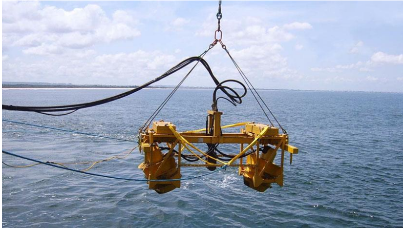
Afbeelding 4-5 Voorbeeld van een MFE tool (Twin R2000 van James Fisher Subsea Excavation)
