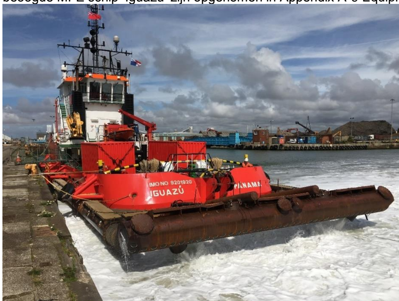
Afbeelding 4-4 Mass Flow Excavation met de Iguazú
