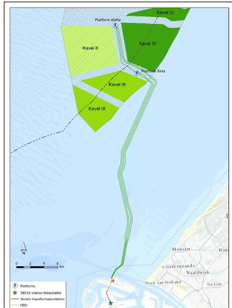
Afbeelding 1-1 Route van de export zeekabels tussen het wind park Hollandse Kust (zuid) en het transformatorstation op de Tweede Maasvlakte
