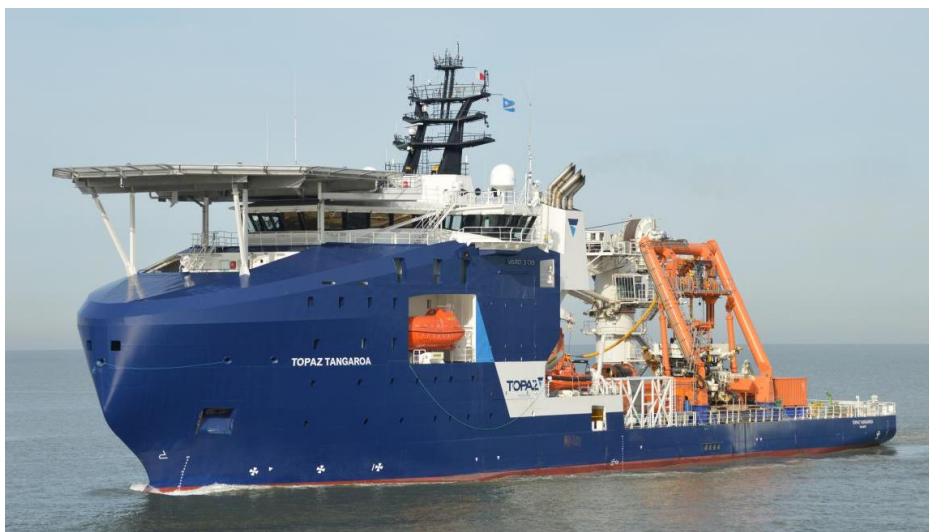
Afbeelding 6-1 TSV 'Topaz Tangarao' met aan dek de trencher Q1600 'Dig-It'
