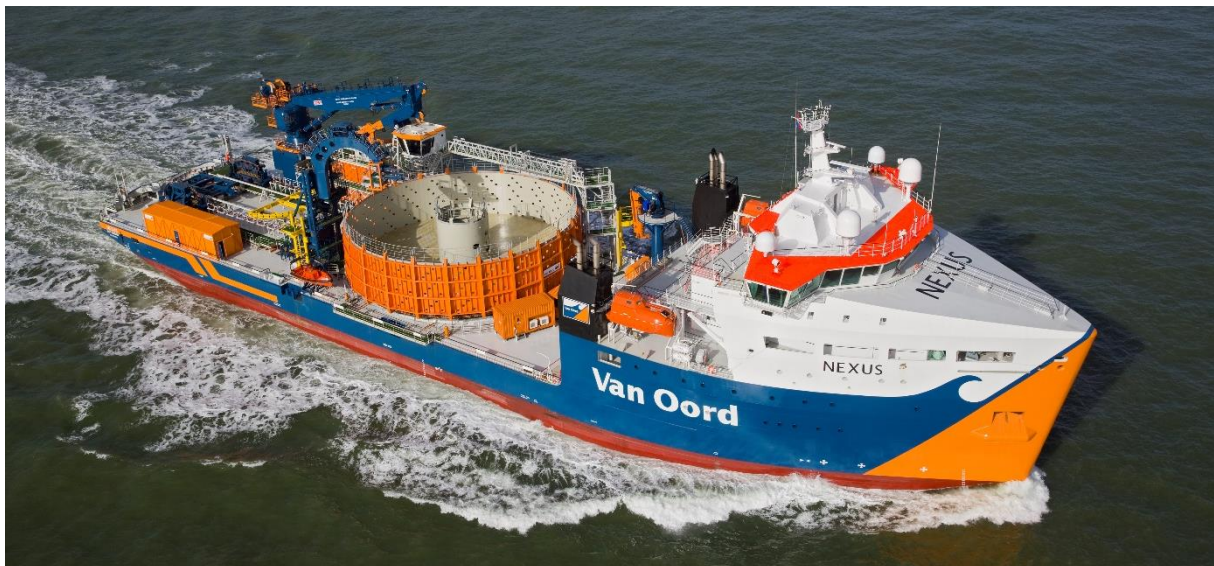
Afbeelding 5-1 Kabelinstallatieschip (CLV) 'Nexus'
