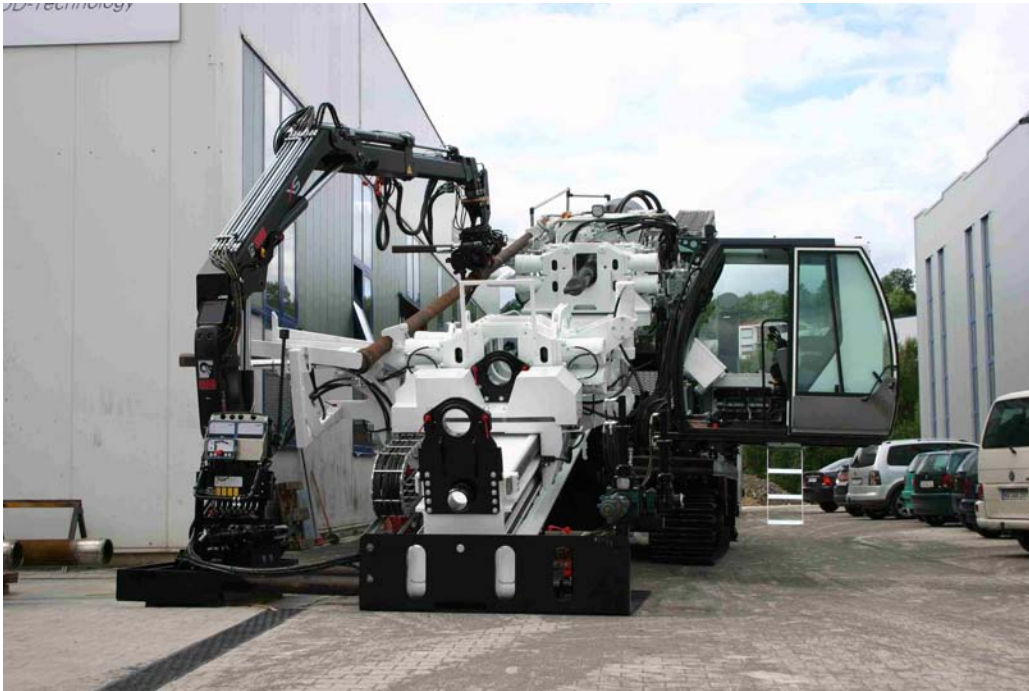
Afbeelding: 250 tons boor-rig Van Vulpen
