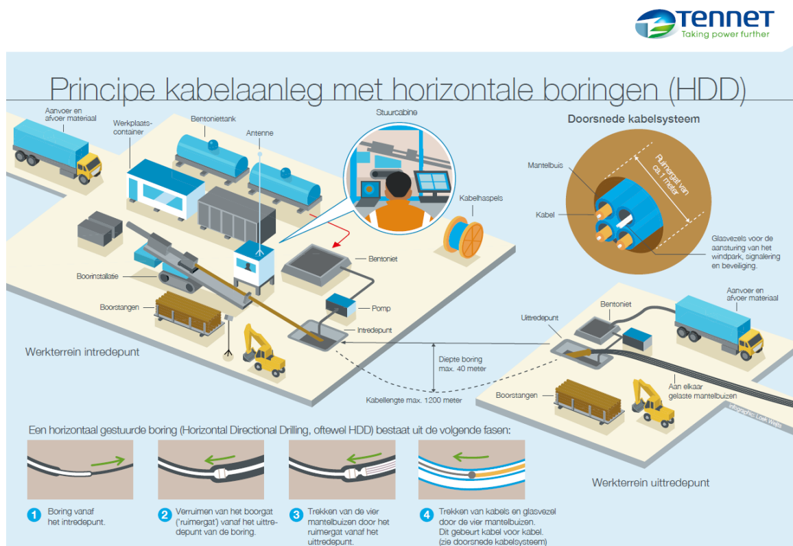
Afbeelding 2.4 Aanleg kabelverbindingen met een horizontaal gestuurde boring
