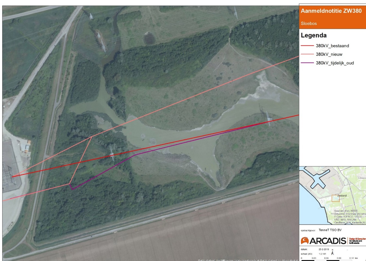
Figuur 2 Situatie zoals opgenomen in het Rijksinpassingsplan. Rood geeft de bestaande (permanente) 380 kV-lijn aan die gaat worden vervangen. Roze geeft de nieuwe (permanente) 380 kV-lijn aan. De tijdelijke lijn uit het Rijksinpassingsplan is aangegeven met een paarse kleur.
