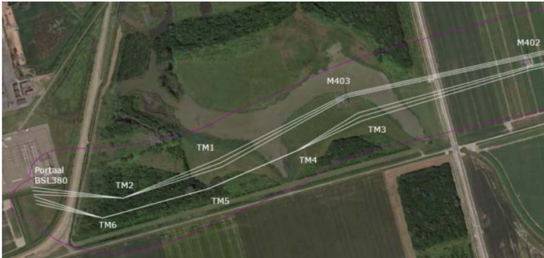
Figuur 4 0,4 \mu T zone (paarse contour) conform de RIVM-handreiking (bron: Definitief Ontwerp – Aansluiting BSL380 met tijdelijke lijn – Realisatie geleidermontage ZW380W)
