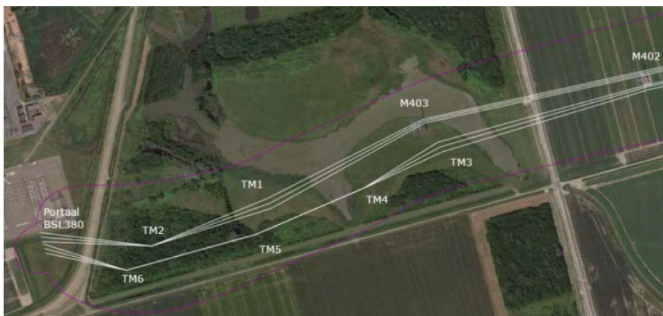
Afbeelding 5 De 0,4 \mu T zone (paarse contour) conform de RIVM-handreiking (bron: Definitief Ontwerp – Aansluiting BSL380 met tijdelijke lijn – Realisatie geleidermontage ZW380W)
