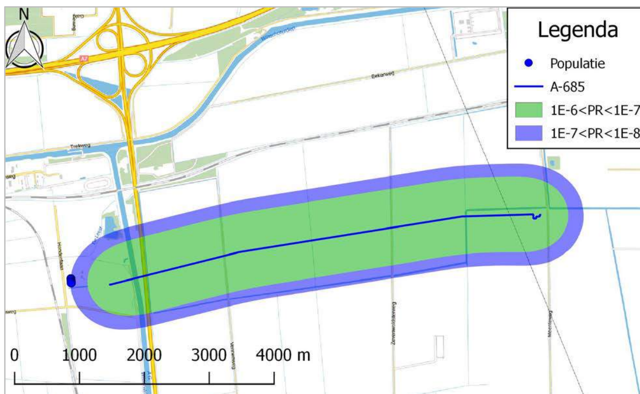
Figuur 3 Ligging van gastransportleiding A-685 (donkerblauw). Het PR-niveau van 10^{-6} per jaar wordt niet bereikt.
