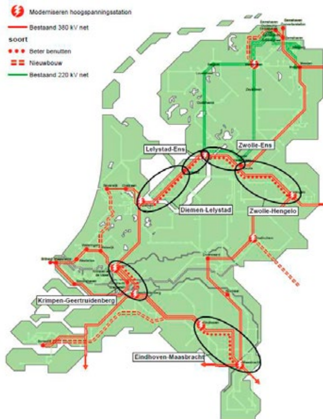
Figuur 1 de 380kV-verbindingen die onderdeel zijn van het programma Beter Benutten Bestaande 380kV-verbindingen
