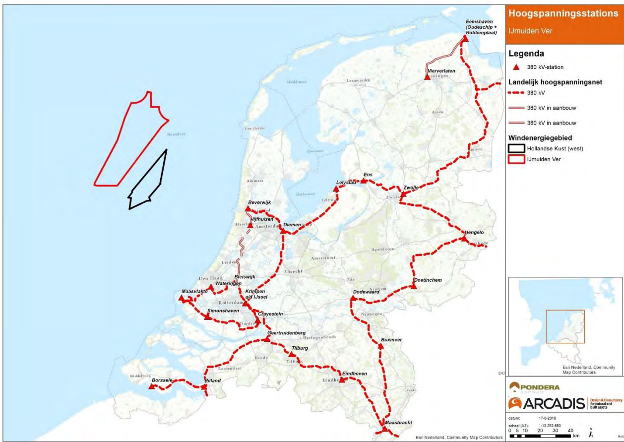
Figuur 2-4 Hoogspanningsstations die in deze paragraaf zijn beschouwd voor aansluiting IJmuiden Ver.
