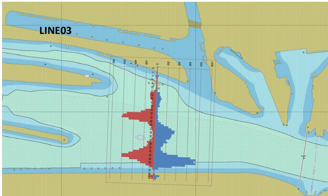
Figuur 5-6 Verdeling van het verkeer over de vaarweg bij line3, net na de sluizen (lanes van 10 m).
