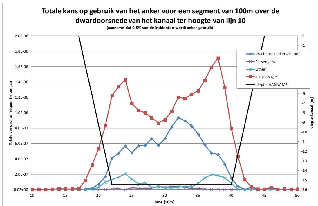
Figuur 5-11 Totale kans op gebruik van het anker per vak van 10m x 100m per jaar ter hoogte van lijn 10.
