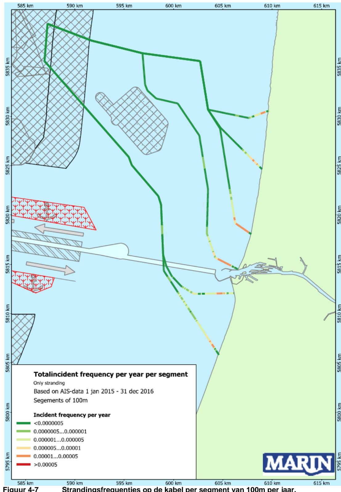
Figuur 4-7 Strandingsfrequenties op de kabel per segment van 100m per jaar.
