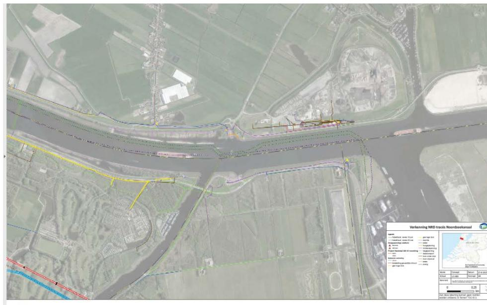
Figuur 5-4 Overzicht kabel tracé door het Noordzeekanaal (dd 19 juni 2017), groene lijn is de kabel; locatie 4 (aanlanding voor Afrikahaven)
