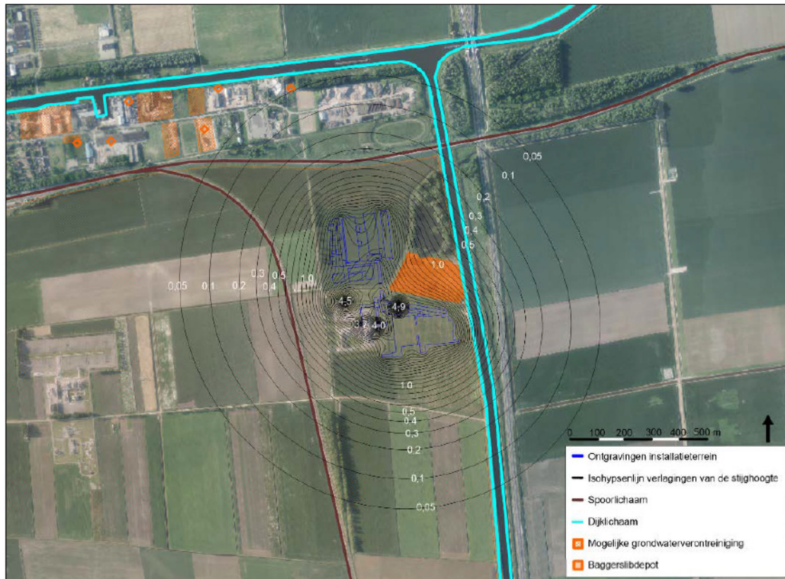
Figuur 4-1: Stationair berekende verlagingen ten opzichte van een hoge uitgangsstijghoogte. Het betreft hier de diepste ontgravingen ontgravingen en derhalve de meest extreme situatie.
