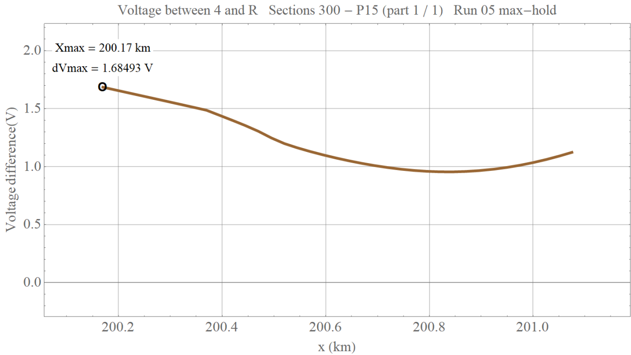
Afbeelding 42: Maximaal optredende spanning tussen bovenleiding en spooreplacement 2 (geleider 4 en R) op opstelrein.
