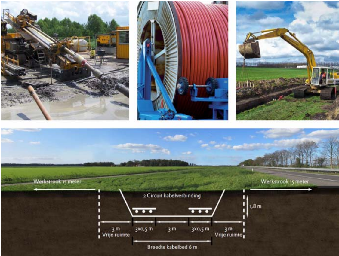
Figuur 2.9 Principe schets voor een kabelbed met werkstrook voor een ondergrondse 150 kV-verbinding
