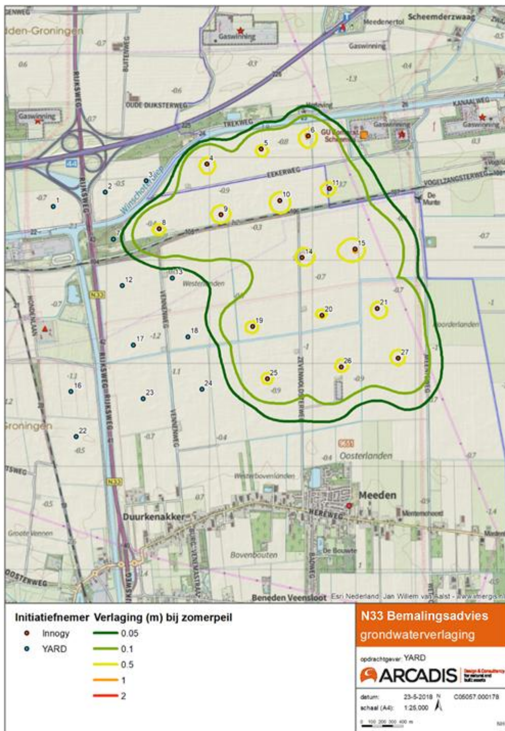
Figuur 10 Maximale verlaging in het cluster Noord bij gescheiden uitvoering voor de grondwateronttrekking van de fundaties inclusief kraanopstelplaatsen van innogy.
