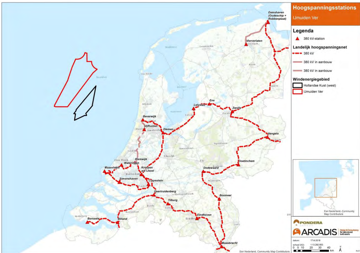
Figuur 5-4 Hoogspanningsstations die in deze paragraaf zijn beschouwd voor aansluiting IJmuiden Ver.
