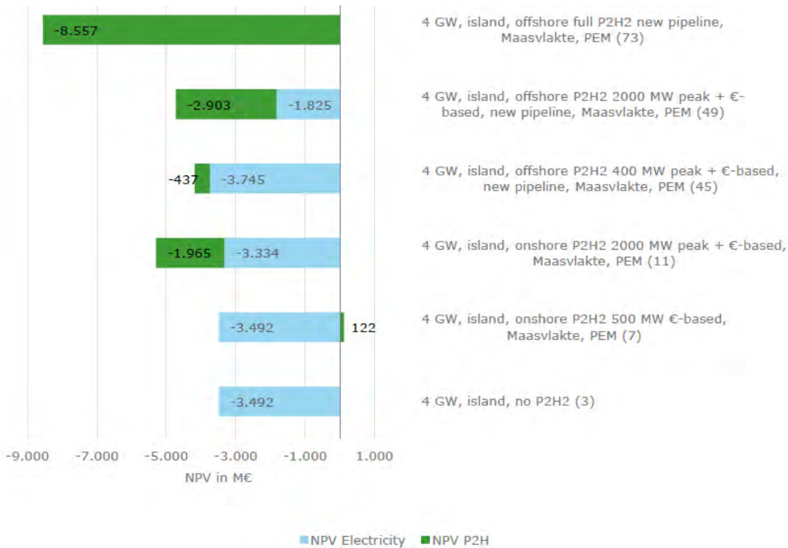
Figuur 9-4 Netto contante waarde berekeningen van de verschillende scenario's (Power-to-Hydrogen IJmuiden Ver, DNV-GL, 2018).
