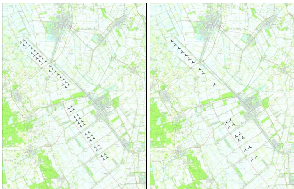
Figuur 4.12 Opstelling dubbele lijnen (links 'kleine' turbine, rechts 'grote' turbine)
