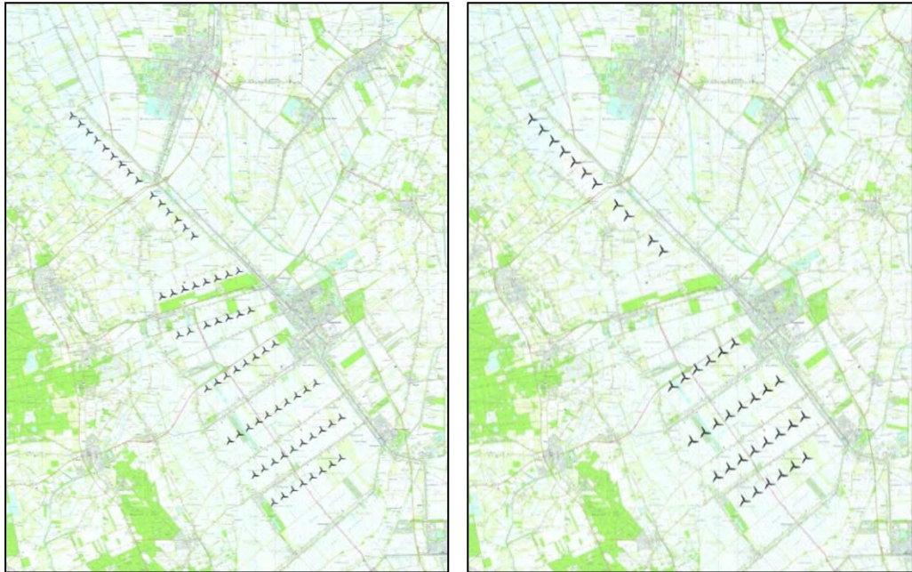
Figuur 4.13 Opstellingen haakse lijnen (links 'kleine' turbine, rechts 'grote' turbine)
