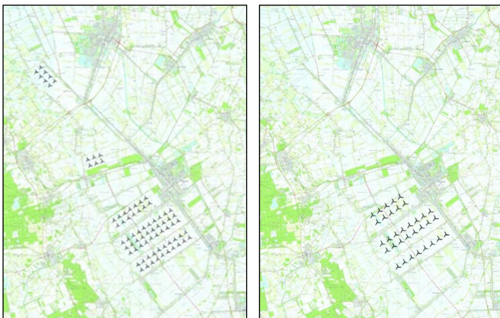
Figuur 4.14 Opstellingen raster (links 'kleine' turbine, rechts 'grote' turbine)
