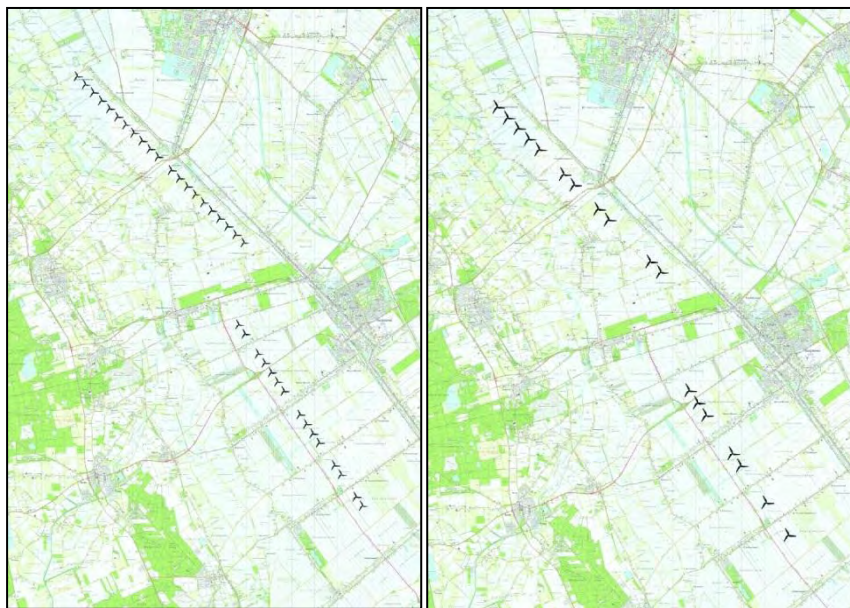
Figuur 4.11 Opstelling enkele lijn (links 'kleine' turbine, rechts 'grote' turbine)
