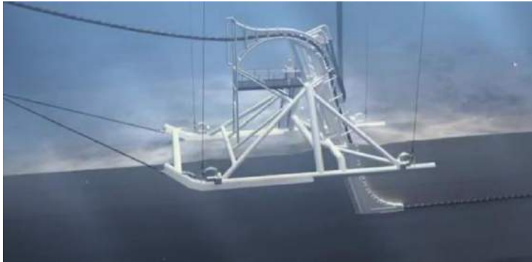
Afbeelding 2.4 Jetting tool (Burial sledge system VBMS). Bron: www.vbms.com
