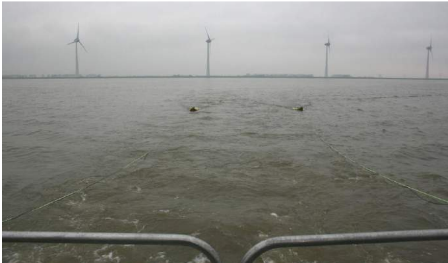
Afbeelding 4. Sleepopstelling van de magnetometers
