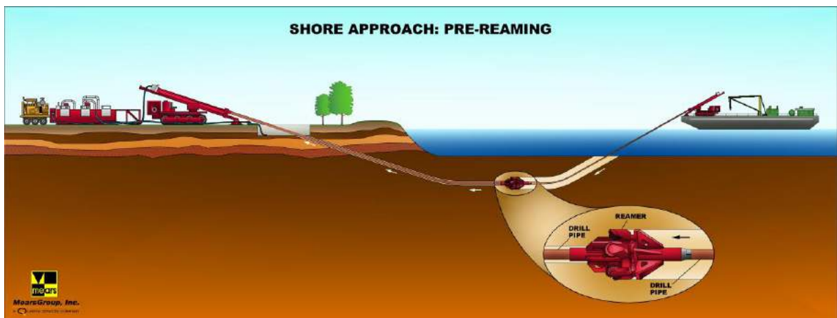
Afbeelding 2.6 Ruimfase van een HDD. Bron www.mearshdd.net
