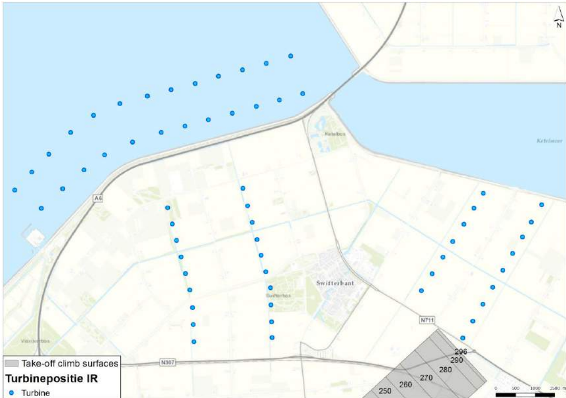
Afbeelding 6.34 Turbines in Basisalternatief IR nabij de take-off climb surfaces (hoogtes in m n.a.p.)
