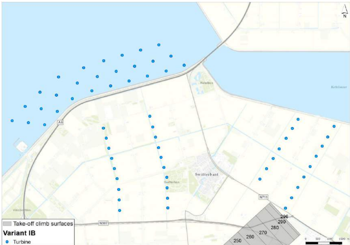
Afbeelding 6.42 Turbines in variant IB nabij de take off climb surfaces (hoogte in m n.a.p.)
