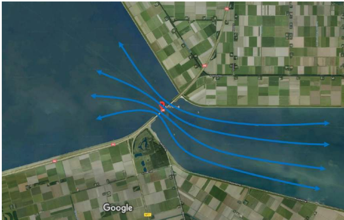
Afbeelding 9.3 Vernauwing van de waterstroom bij de Ketelbrug
