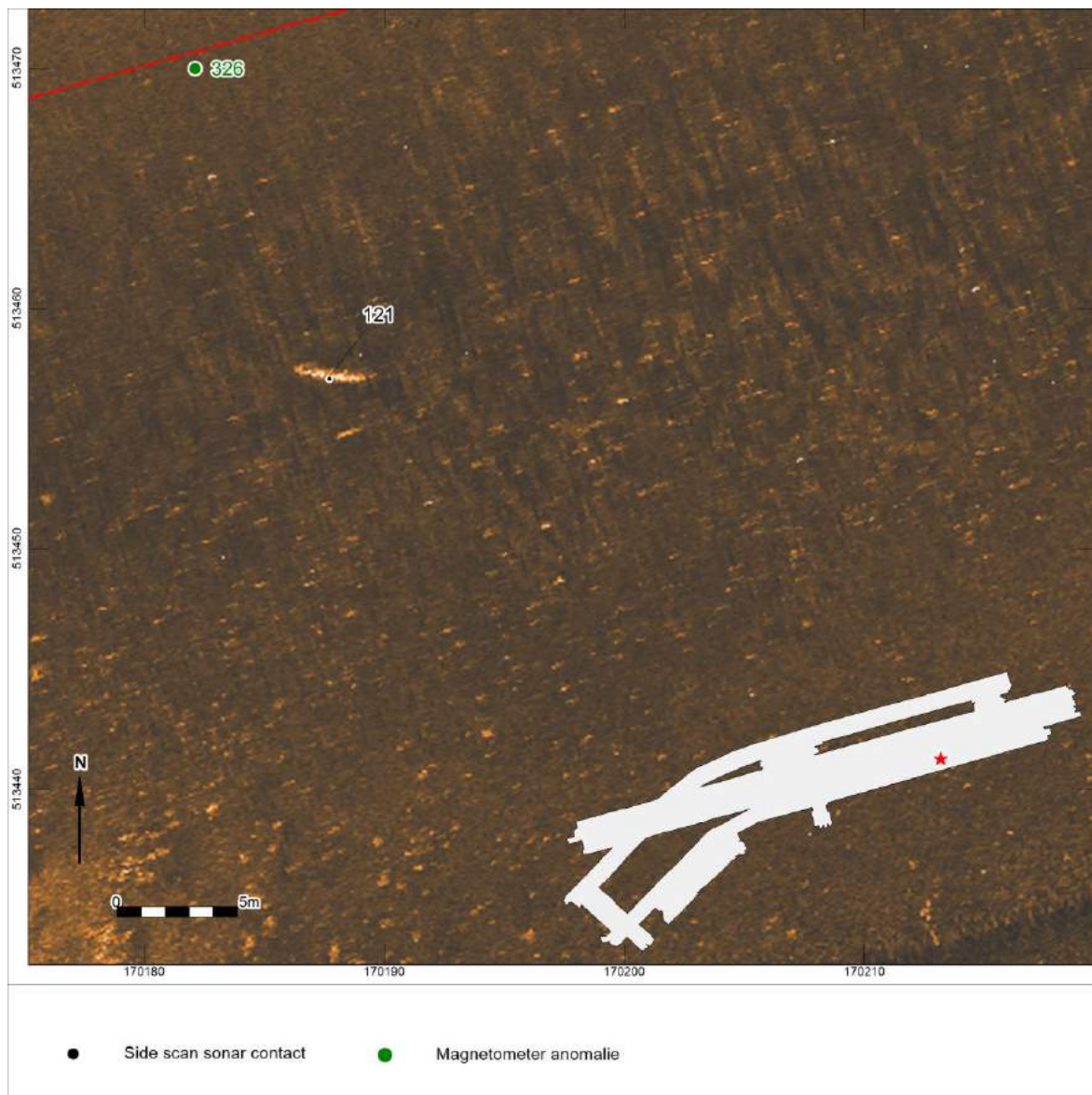
Afbeelding 12. Sonarbeeld van contact 121, een langwerpig object in een oude zandwinput
