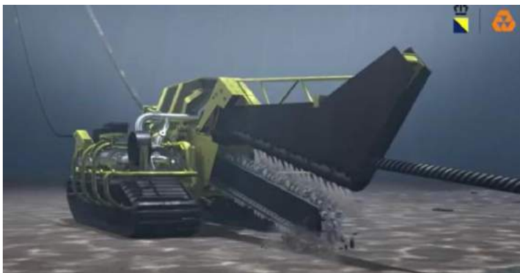
Afbeelding 2.3 Chain cutter (trench former VBMS). Bron: www.vbms.com
