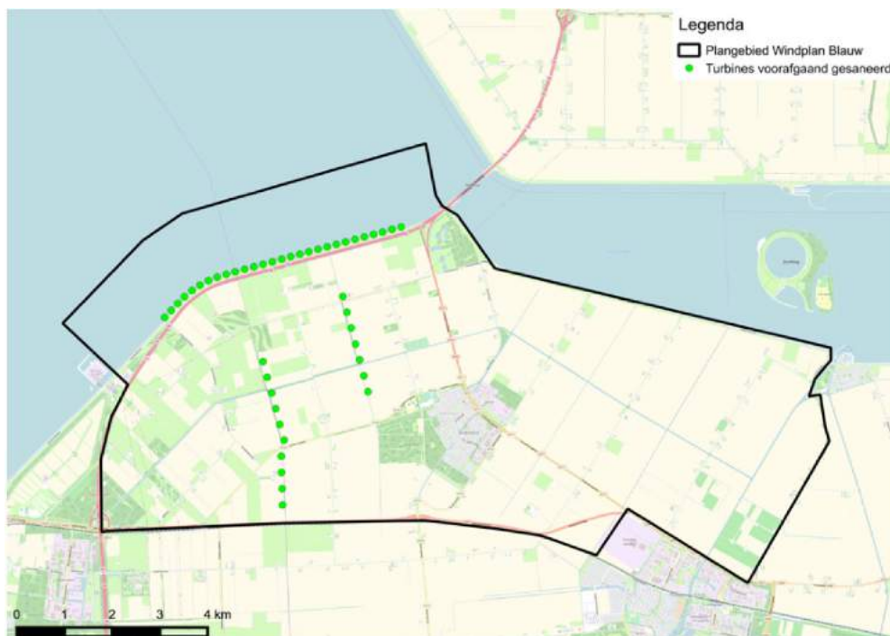
Figuur 2.3 Windturbines (N=45) die voorafgaand aan de bouw van de nieuwe windturbines buiten gebruik worden genomen. Voor de 28 buitendijkse windturbines in het IJsselmeer (het bestaande Windpark Irene Vorrink) geldt dat de bestaande windturbines niet draaien tijdens de bouw van de nieuwe windturbines in het water indien deze bouw plaatsvindt in de periode 1 augustus t/m 31 maart om in deze maanden een rustige kustzone aan te bieden voor watervogels die tijdens de bouw mogelijk op het open water verstoord worden. Het bestaande Windpark Irene Vorrink is verwijderd voordat de nieuwe windturbines in gebruik worden genomen.
