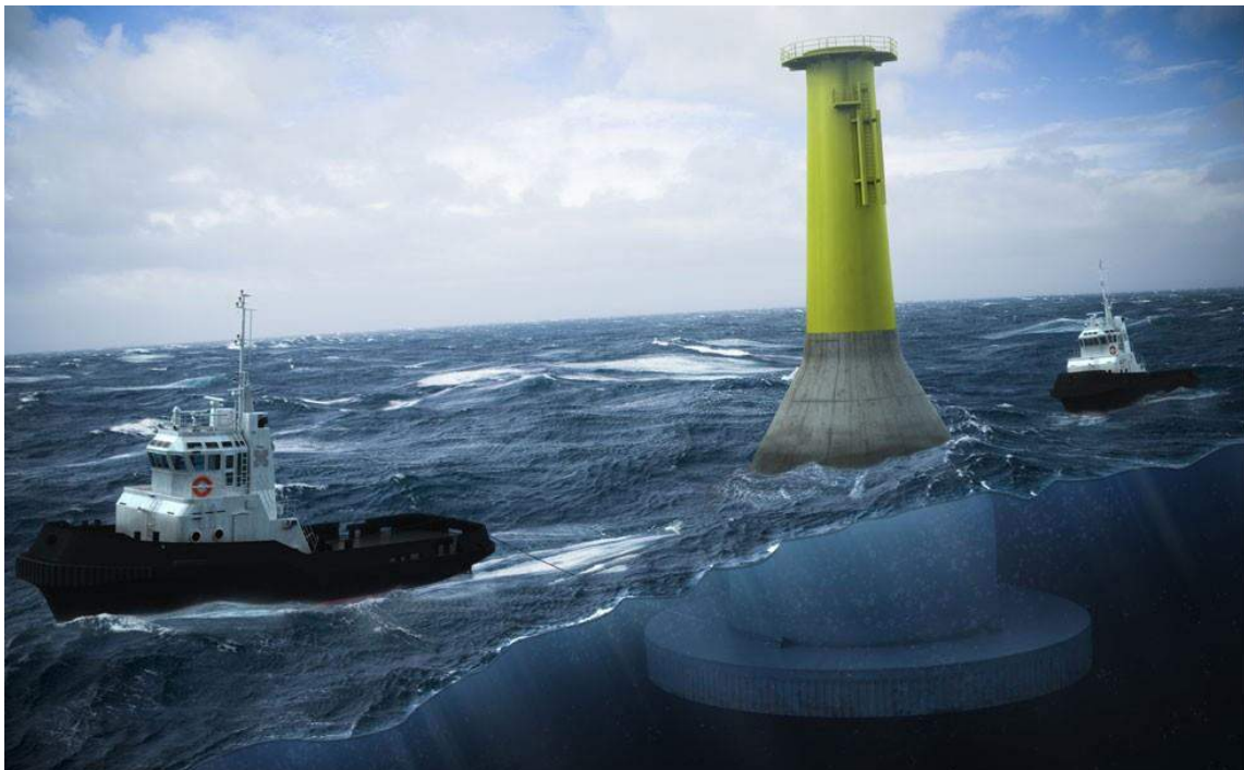
Afbeelding 4.7 Illustratie van een Gravity Based Foundation
