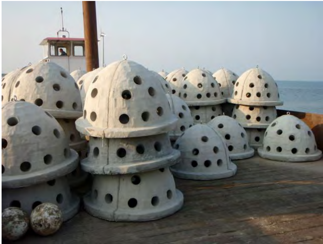
Figuur 9.2. Betonnen rifballen gebruikt in het experiment Waterproeftuin Natuurlijker Markermeer en IJmeer.
