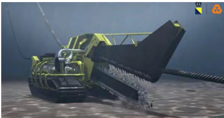
Afbeelding 2.3 Chain cutter (trench former VBMS). Bron: www.vbms.com
