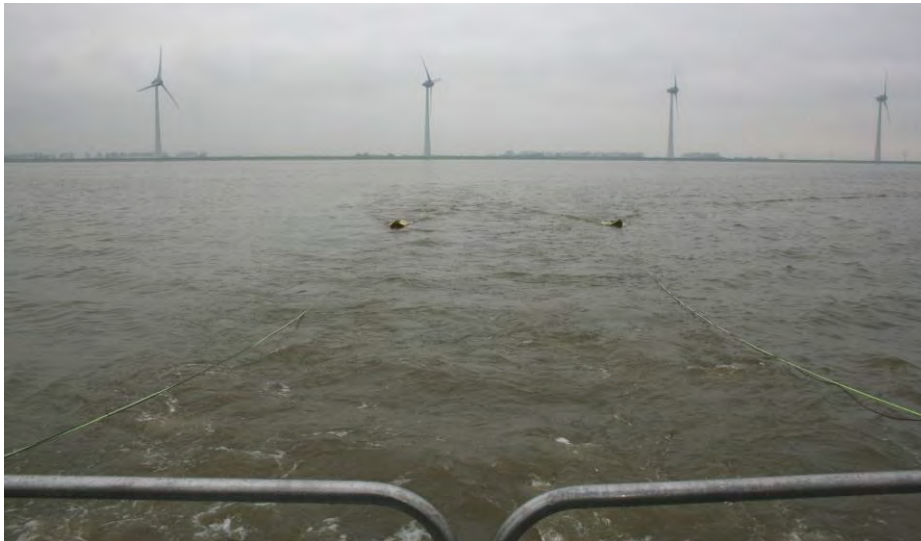
Afbeelding 4. Sleepopstelling van de magnetometers
