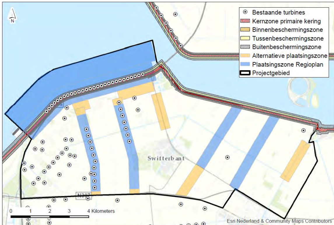
Afbeelding 5.15 Plaatsingszones en beschermingszones uit de legger
