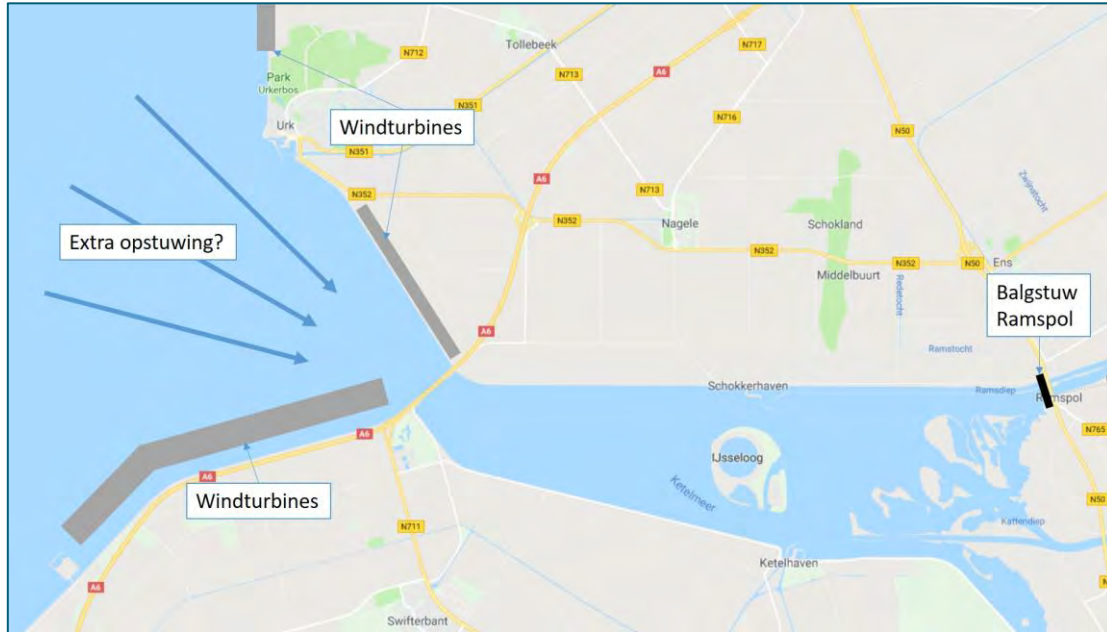
Afbeelding 9.1 Mogelijke extra opstuwing door de windturbines en de invloed daarvan op balgstuw Ramspol
