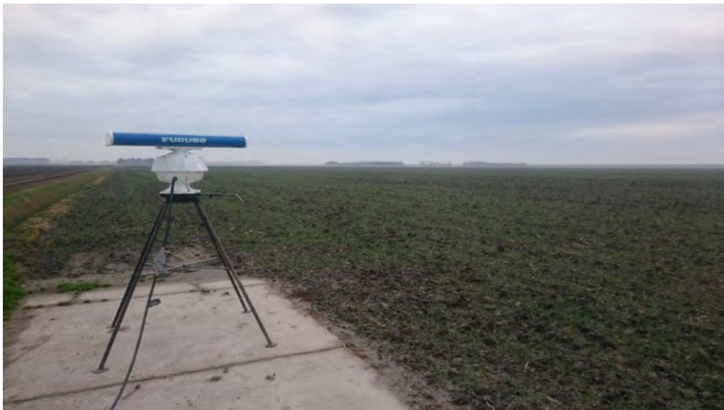
Figuur 2.2 Opstelling horizontale radar (Furuno 12 kW) voor onderzoek aan slaaptrek van ganzen (Flevoland, februari 2017).
