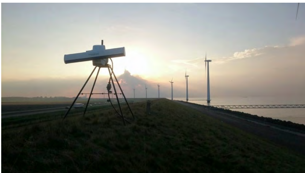
Figuur 2.4 Radar in verticale positie voor de registratie van nachtelijke vogeltrek, IJsselmeerdijk 17 oktober 2016 (foto Daniel Beuker).
