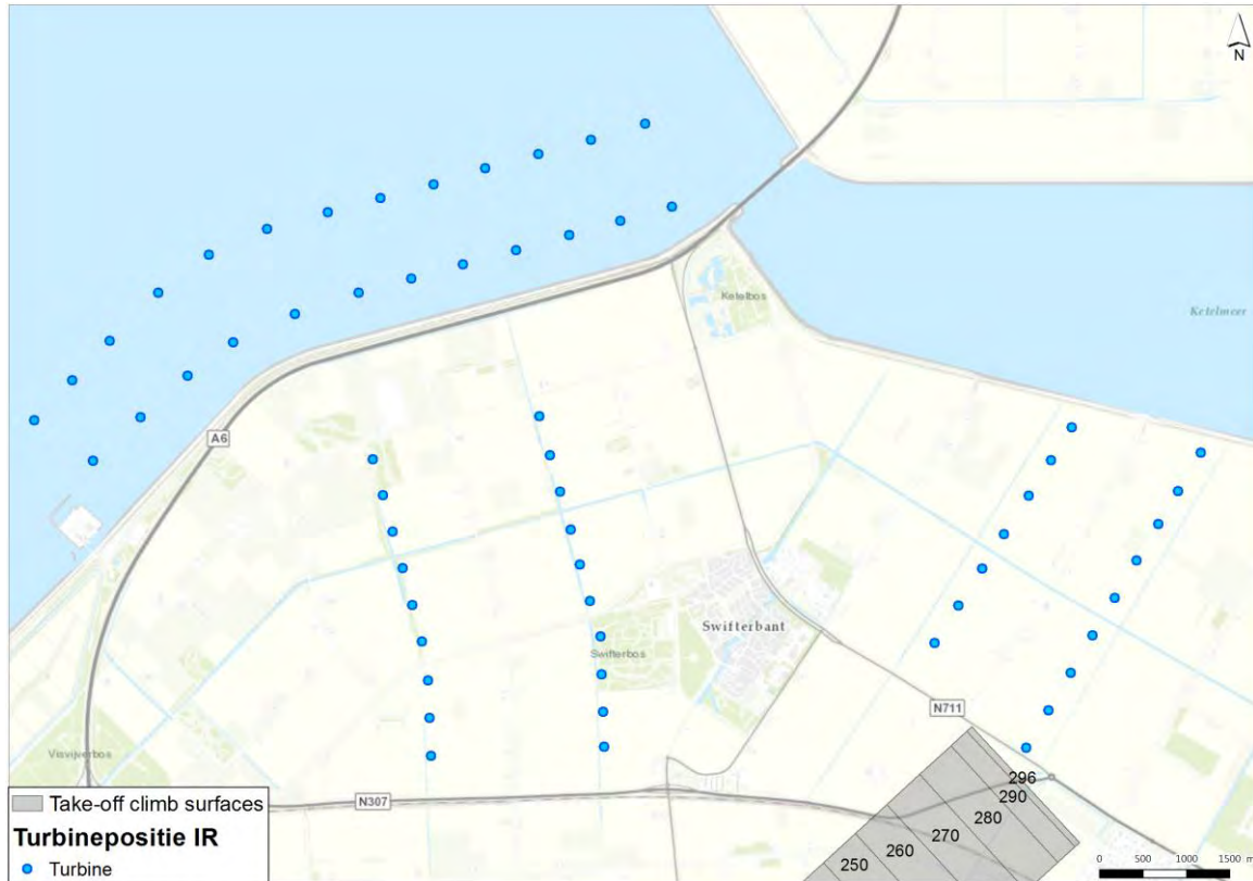
Afbeelding 6.34 Turbines in Basisalternatief IR nabij de take-off (opstijgend verkeer) climb surfaces (hoogtes in m n.a.p.)
