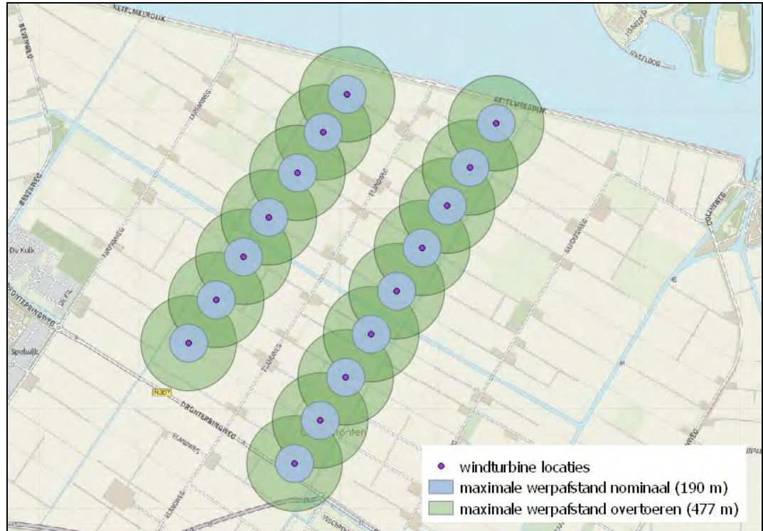
Figuur 5. Maximale werpafstanden van de turbines in deelgebied oost
