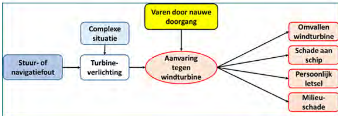
2805 Afbeelding 6.23 Bow-tie diagram voor Aanvaring tegen windturbine
