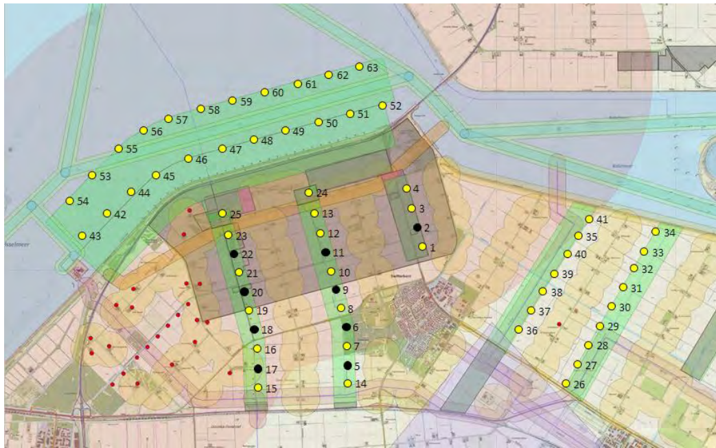
Afbeelding 2.3 Windturbines voorzien van obstakellichting in variant IA
