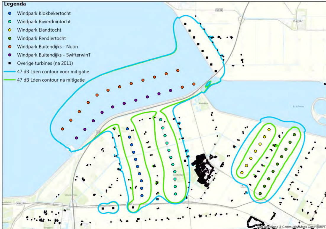
Afbeelding 5.2 47 dB L den geluidscontour voor en na mitigatie
