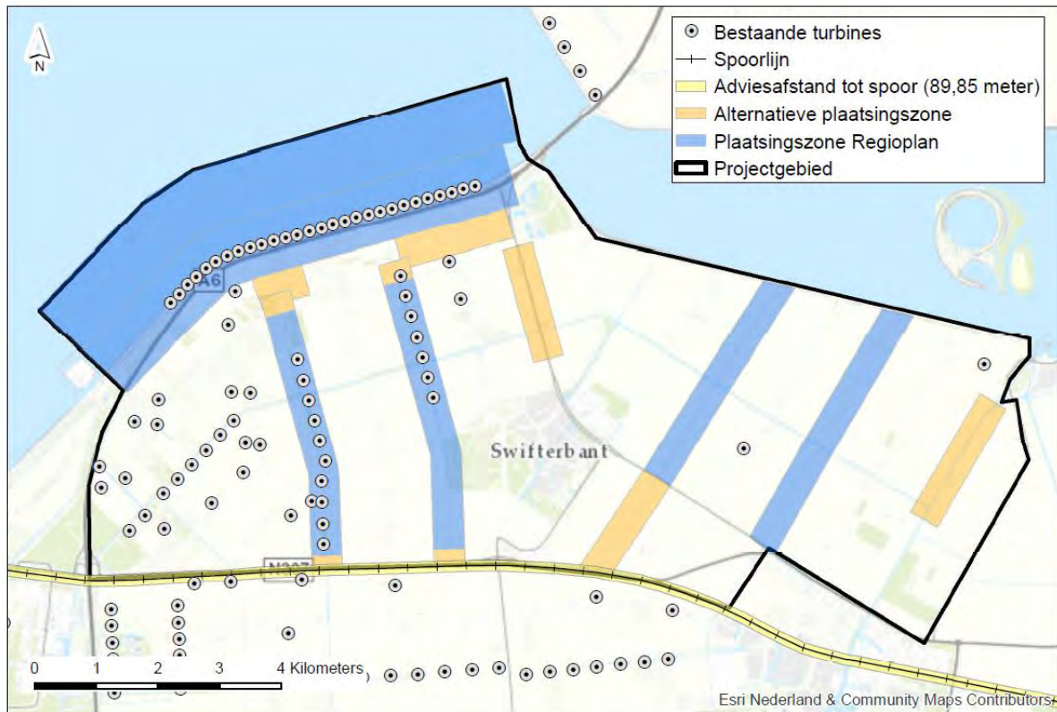
Afbeelding 5.11 Minimumafstand van innovatieve turbines tot het spoor
