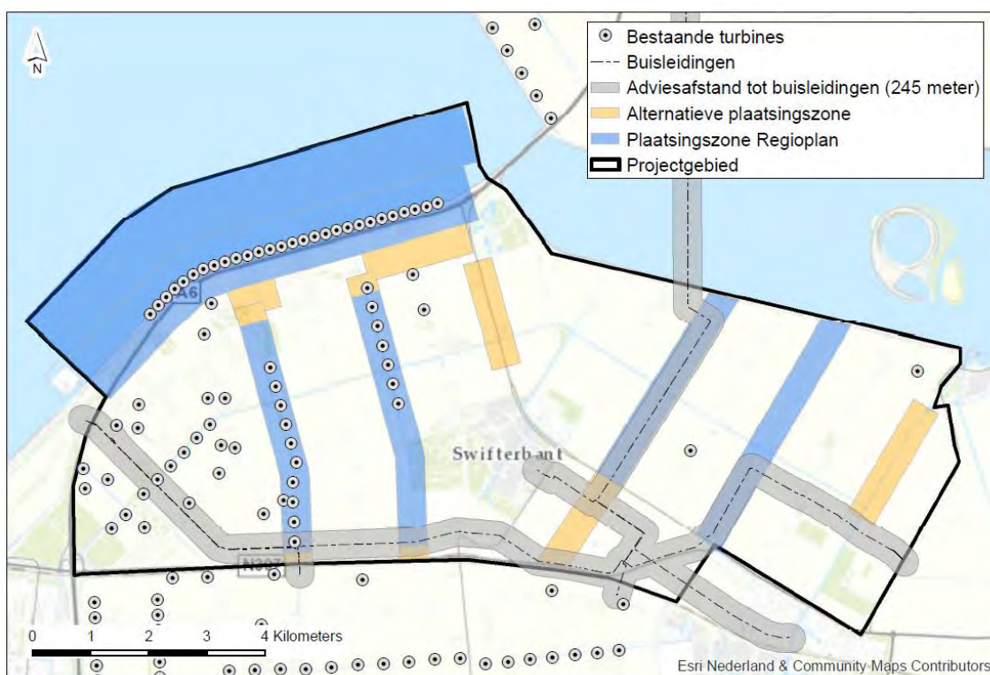
Afbeelding 5.5 Toetsafstand tot buisleidingen voor reguliere turbines
