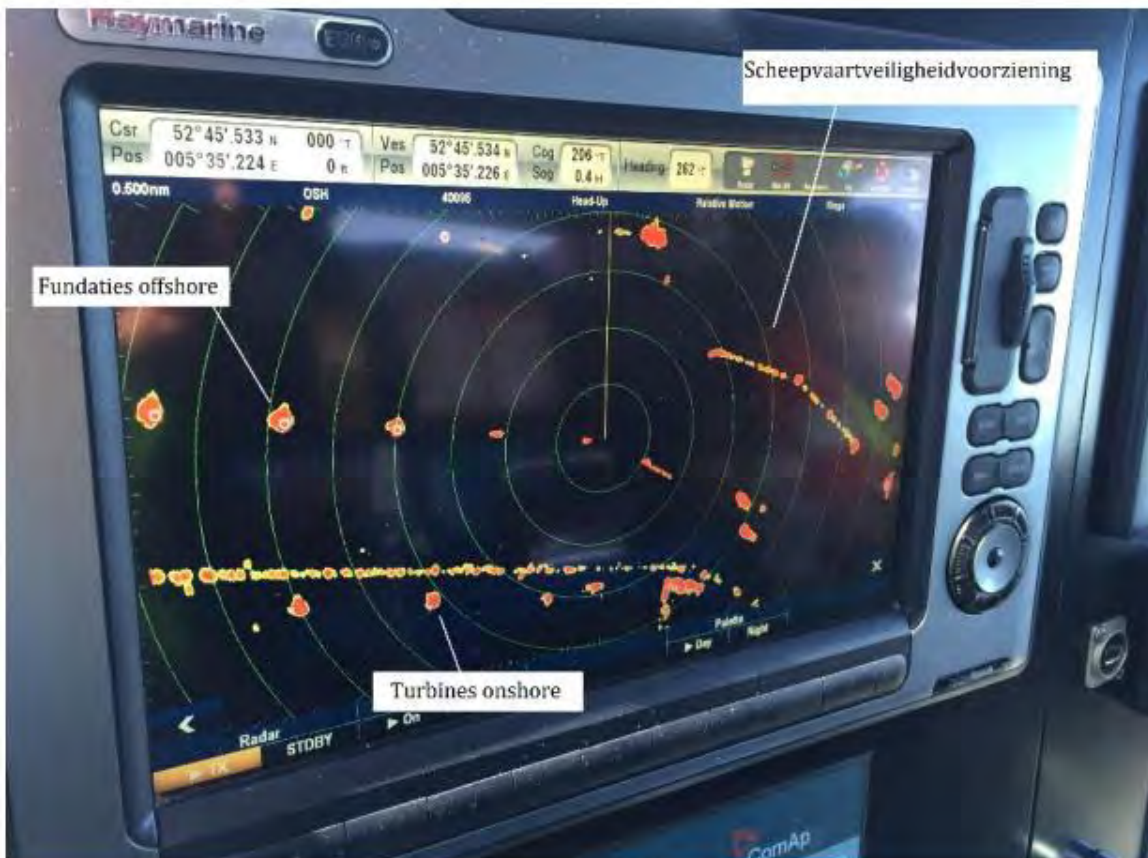
Afbeelding 6.20 Scheepsradarbeeld van Windpark Noordoostpolder (Bron: MER Windpark Noordoostpolder, Pondera Consult )
