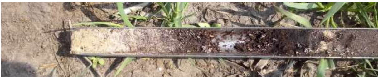
Figuur 24: Het op locatie DEE 2.6 in boring 57 aangetroffen veenlaagje (midden) met links daarvan de vernatte top van het dekzand
