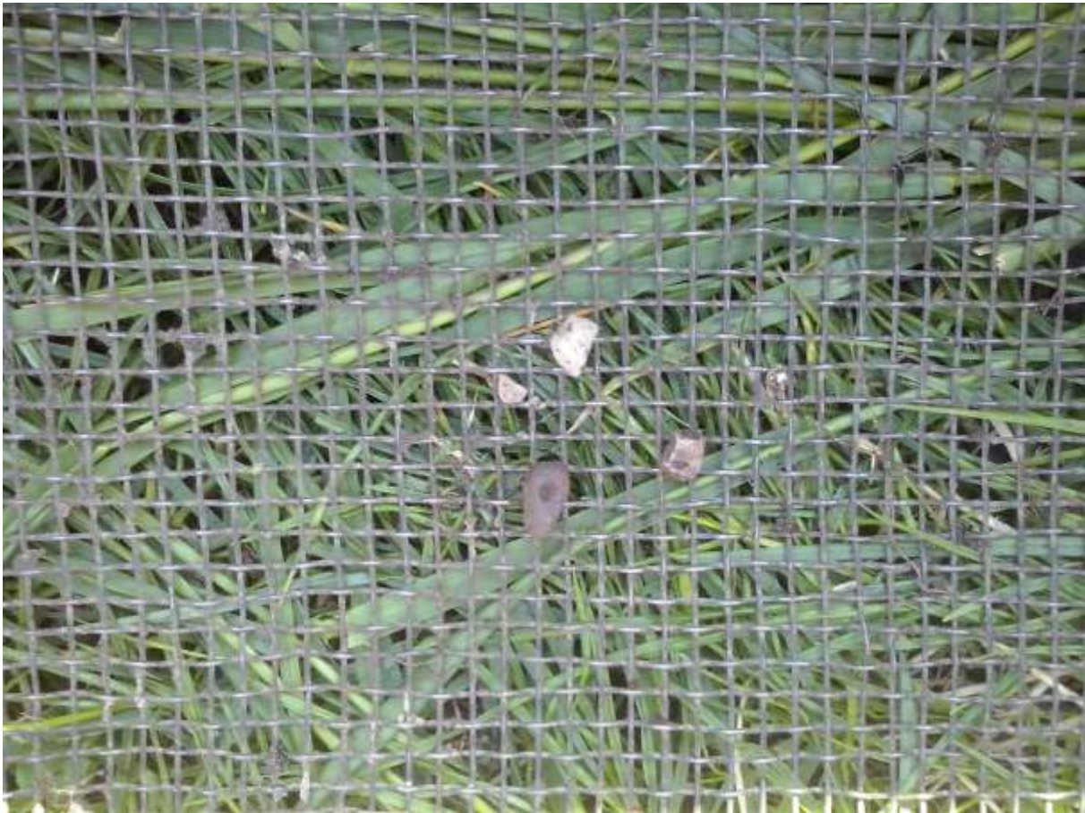
Figuur 2: Foto van natuurlijke grinddeeltjes zoals deze tijdens het zeven in de BC- en de C-horizont zijn aangetroffen.
