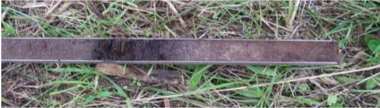
Figuur 17: Deelgebied E, foto van de door veen (links van het midden) afgedekte podzolbodem (rechts) in boring 171 waarvan de top (rechts van het veen), is vernat en doorworteld.
