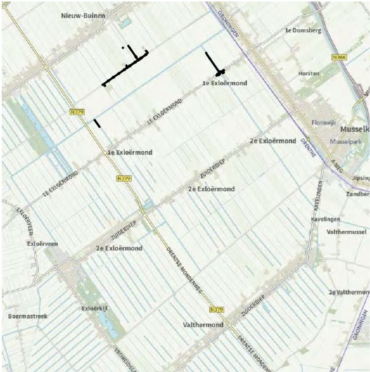
Figuur: Zuidelijk deel plangebied - elektriciteitskabels
