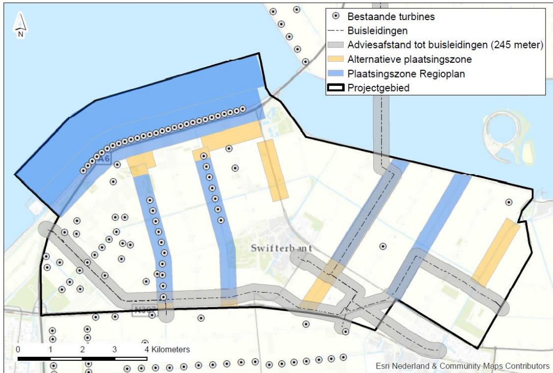
Afbeelding 5.5 Toetsafstand tot buisleidingen voor reguliere turbines
