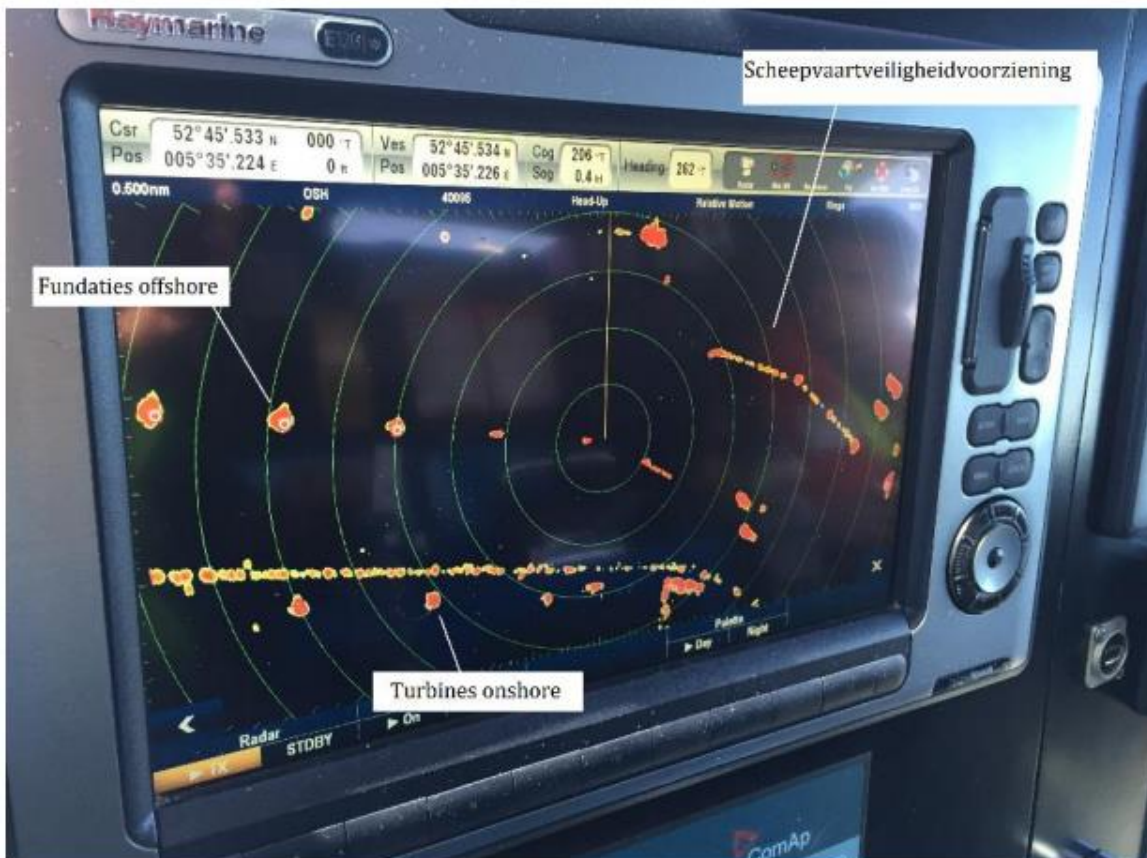
Afbeelding 6.22 Scheepsradarbeeld van Windpark Noordoostpolder (Bron: MER Windpark Noordoostpolder, Pondera Consult )
