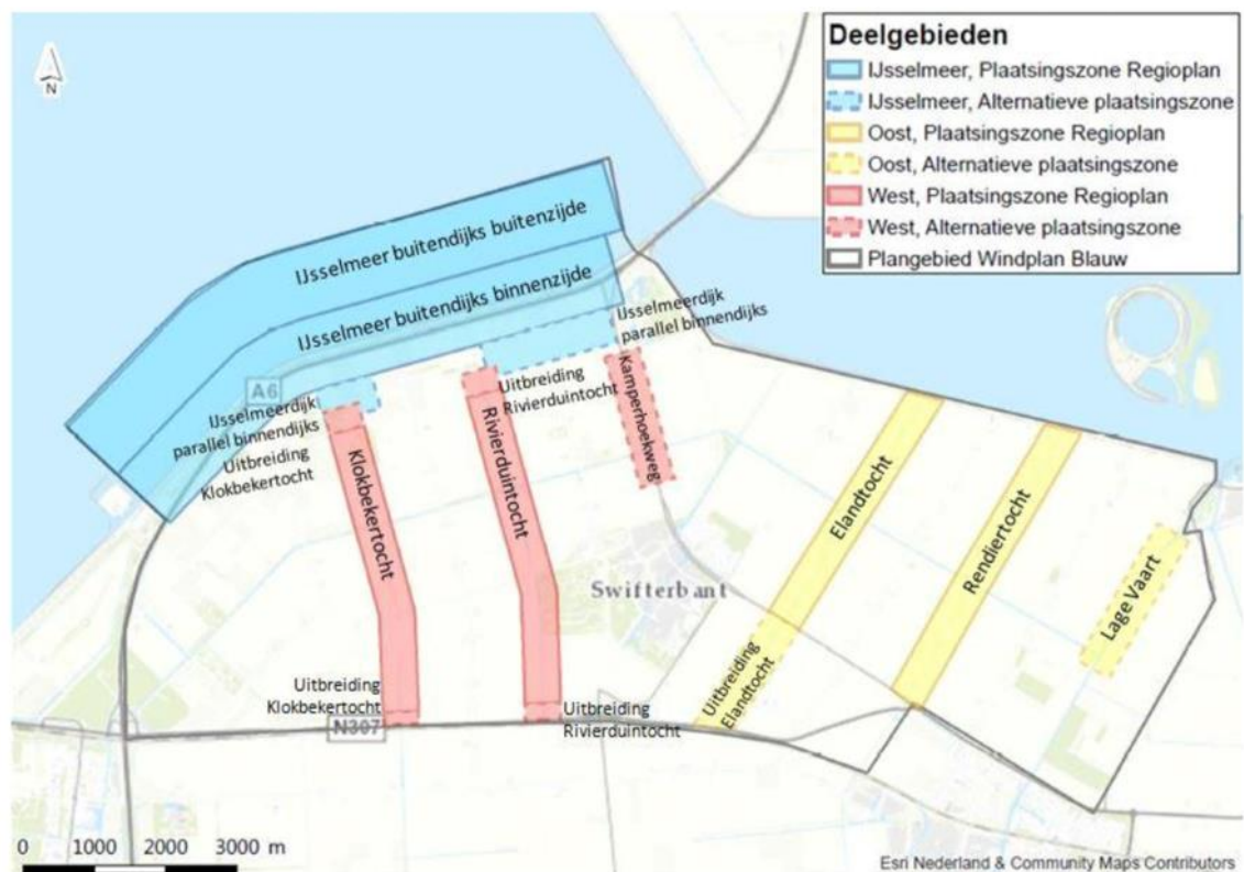
Figuur 2.1 Plaatsingszones windturbines Windplan Blauw
