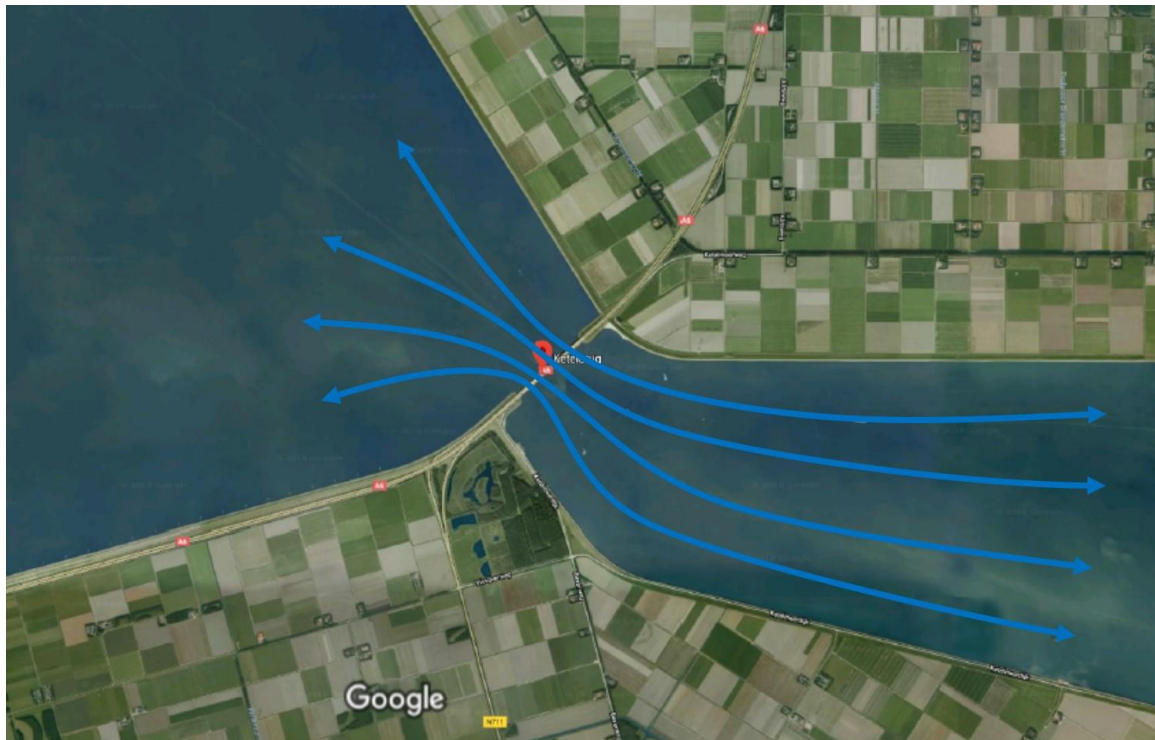
Afbeelding 9.3 Vernauwing van de waterstroom bij de Ketelbrug
