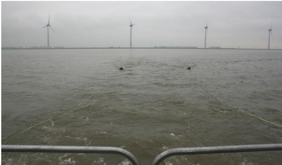
Afbeelding 4. Sleepopstelling van de magnetometers
