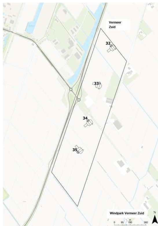
Figuur 1.1 Windturbineposities Windpark Vermeer Zuid
