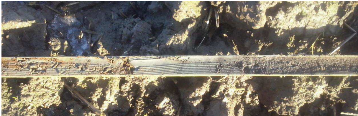
Figuur 3: Foto van boring 12 met klei dat direct op het grijze ongeoxideerde zand van de C-horizont ligt (geheel rechts).
