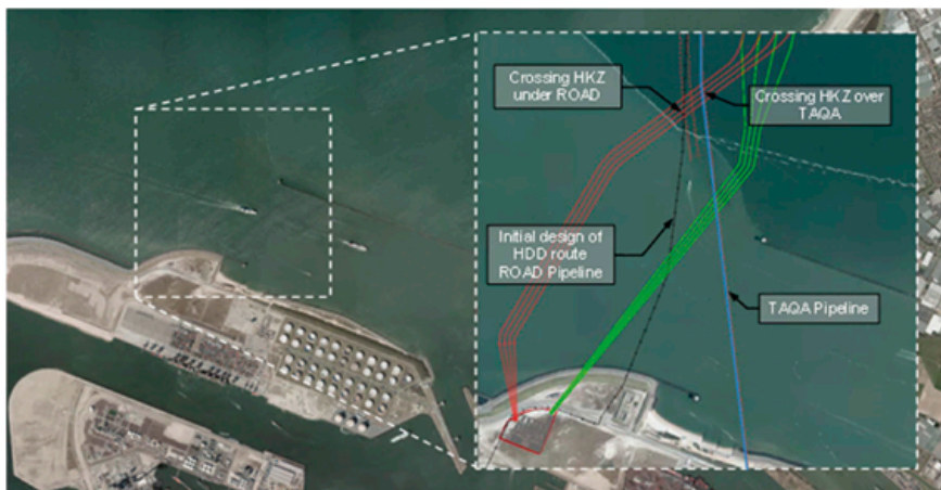
Figuur 1: aanlegmethoden kruising Maasmond
