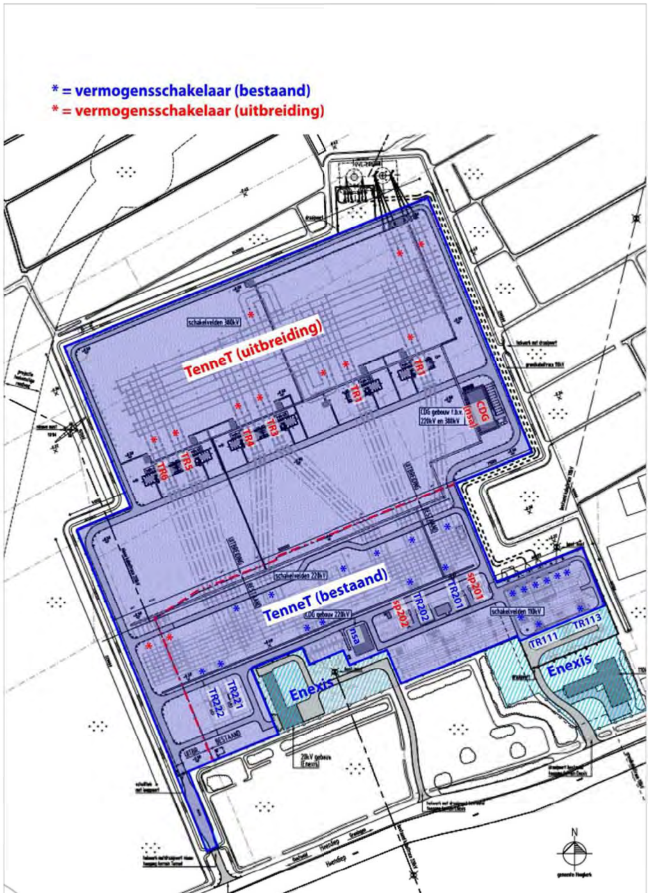
Figuur 2: globale lay-out van het transformatorstation en beoogde uitbreiding, aanduiding relevante geluidbronnen
