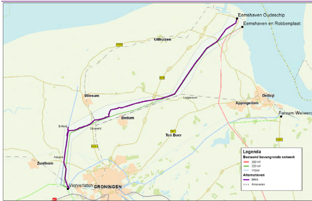
Figuur 7.2 Het tracé van het MMA
