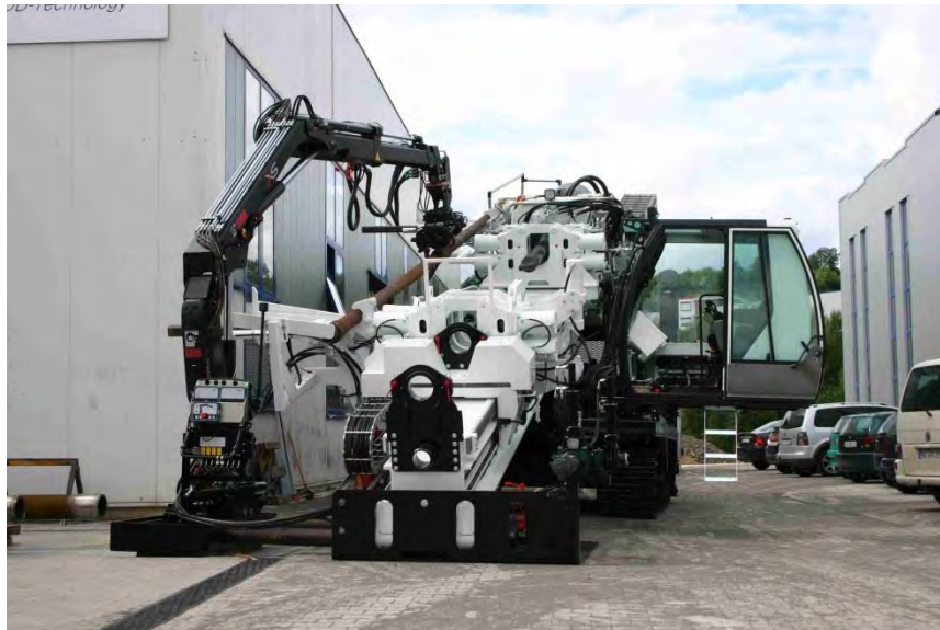
Figuur 4 250 tons boorstelling
