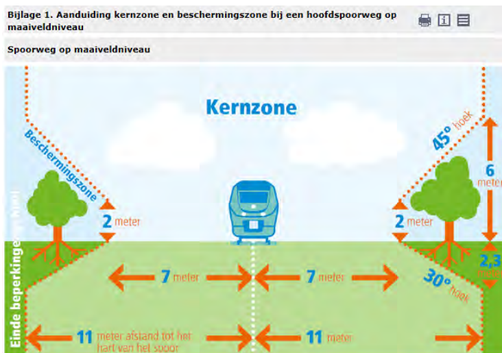
Afbeelding 1.3 Overzicht beperkingenzone spoorweg op maaiveldniveau
