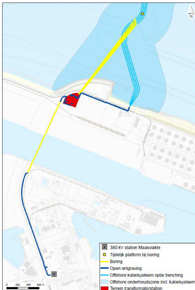
Figuur 6-2 Schematische weergave van de beide aanlandingsopties bij Rotterdam, inclusief de locatie van het tijdelijke ponton bij boring.
