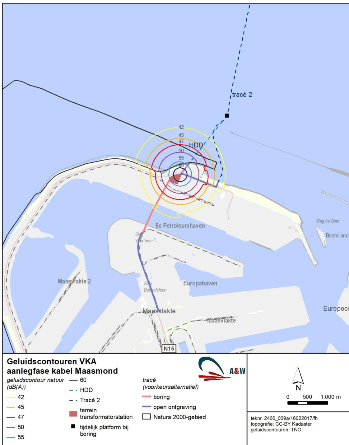
Afbeelding 6.2b Aanlegfase: Geluidscontouren rond HDD boring Maasmond
