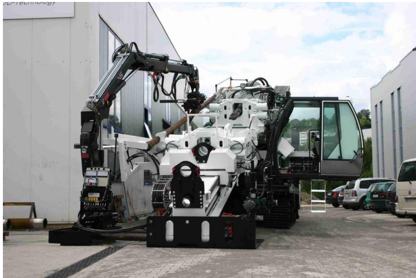
Figuur 4 250 tons boorstelling
