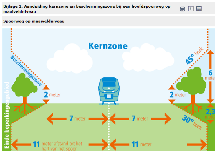
Afbeelding 1.3 Overzicht beperkingenzone spoorweg op maaiveldniveau
