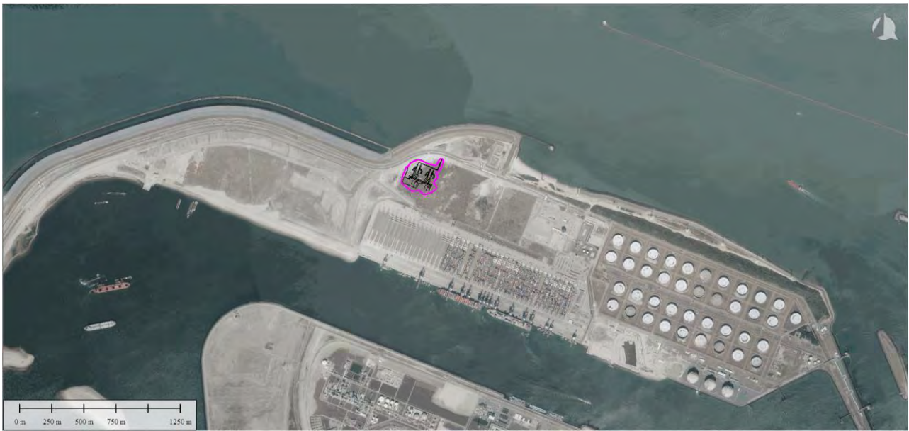
Figuur 6 De 'omhullende 0,4 \mu T contour' het nieuwe 220/380kV transformator station (uitgezoomd)
